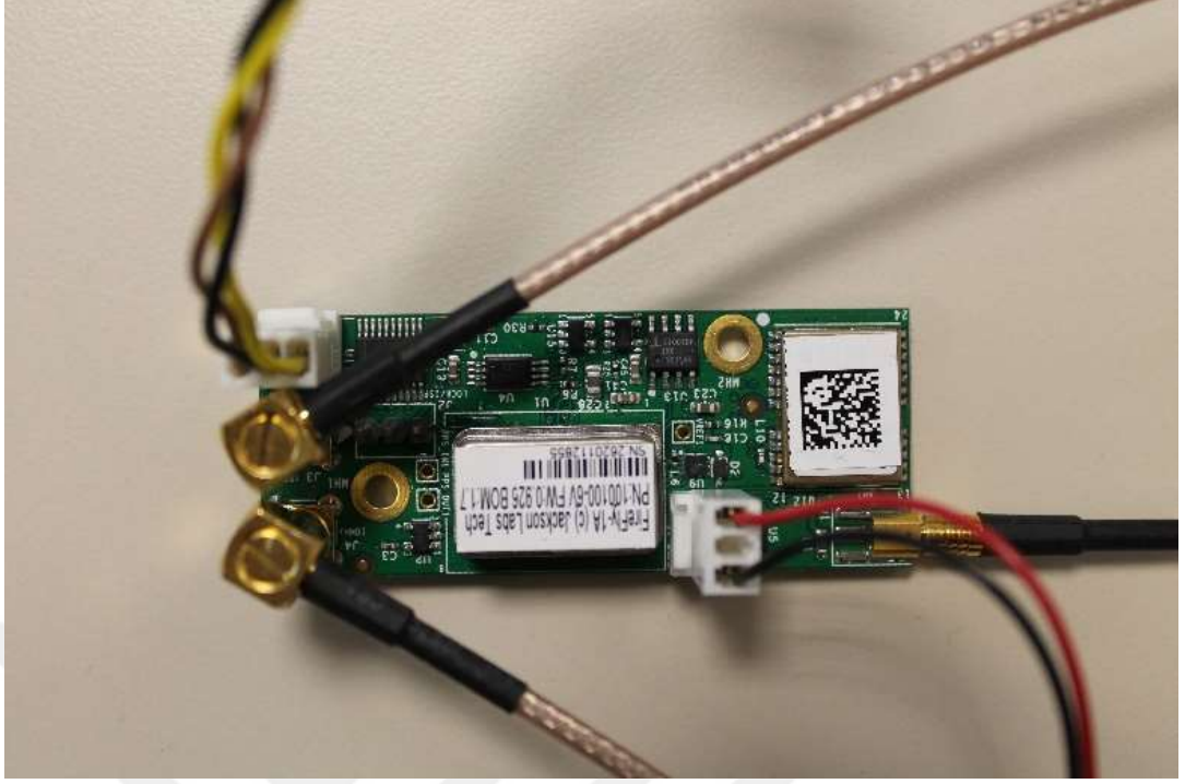
Şekil 4.1. GPS'ten Referans İşareti Üreten Birim
