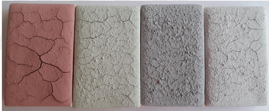
Resim 21: 1050^\circ\text{C} Pişirim öncesi toplanmalı sır görünümleri
