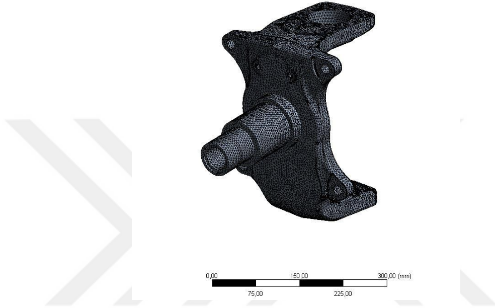
Şekil 3.10 Tekil akson parçasının eleman yapısı
