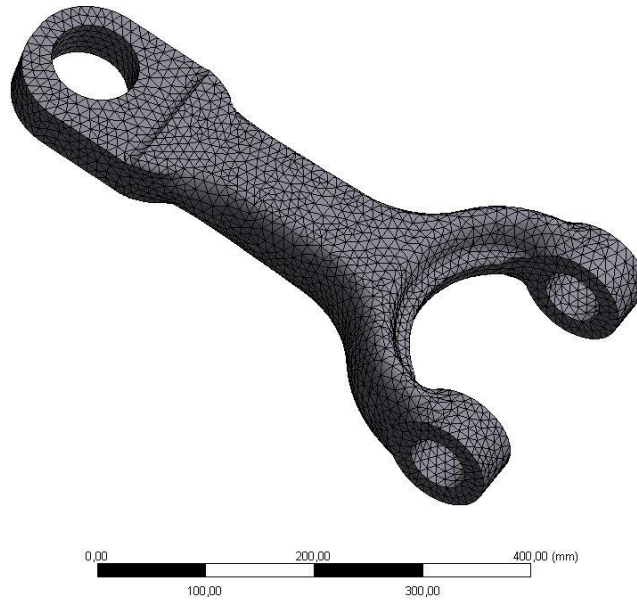
Şekil 3.11 Tekil üst salıncak parçasının eleman yapısı
