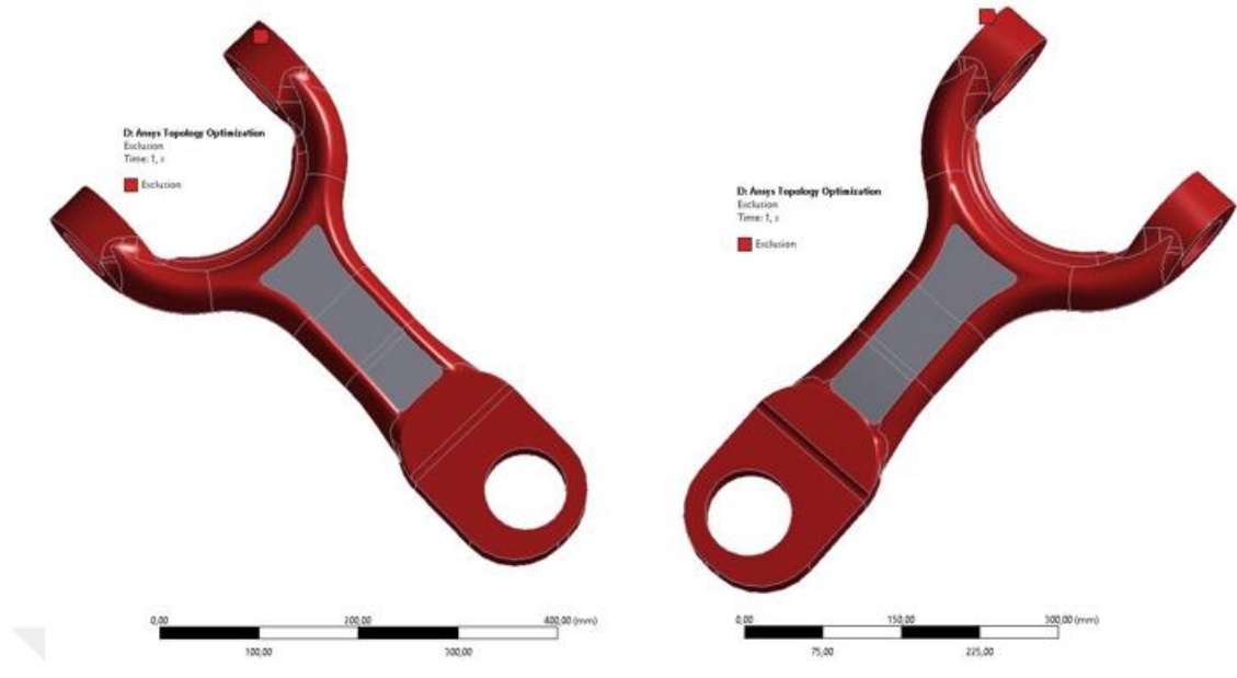
Şekil 4.3 Üst salıncak elemanının kütle azaltılacak bölgelerinin tanımlaması
