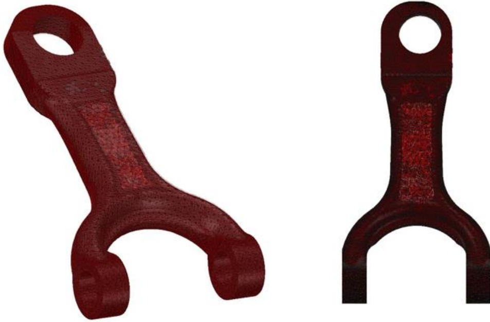
Şekil 4.6 Optimum üst salıncak modelinin katı model programında eşleştirilmesi
