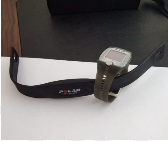
Şekil 11.Nabız ölçümünde kullanılan göğüs bandı ve kol saati (Polar FT1 ve T31- Coded)
