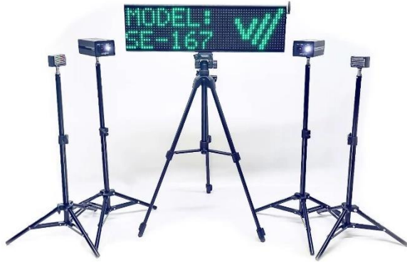
Şekil 12.Performans alımında kullanılan fotosel (Seven, SE-167)
