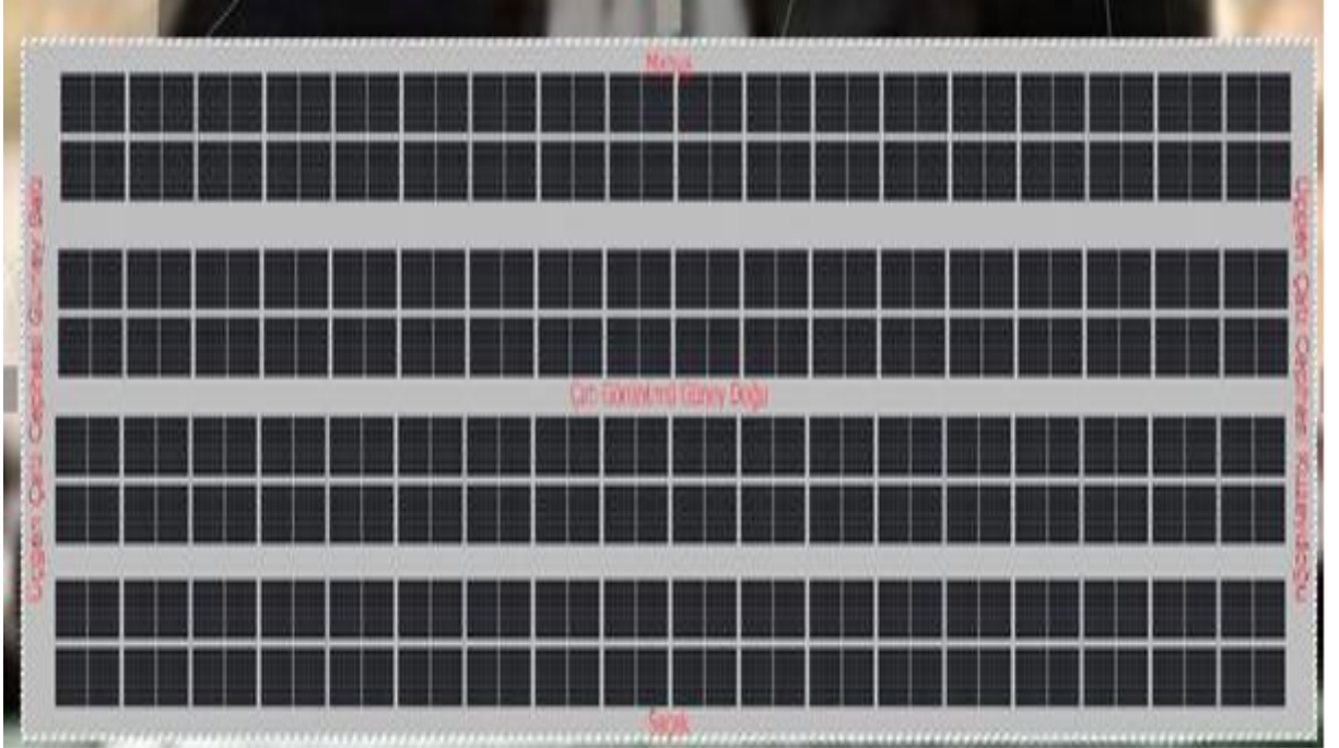
Şekil 5.16 Orta çatıya ait panel yerleşimi
