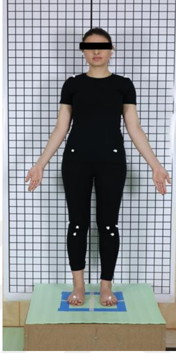
Resim 12: Beyaz polistiren küreler ile işaretlenen antropometrik noktalar.
