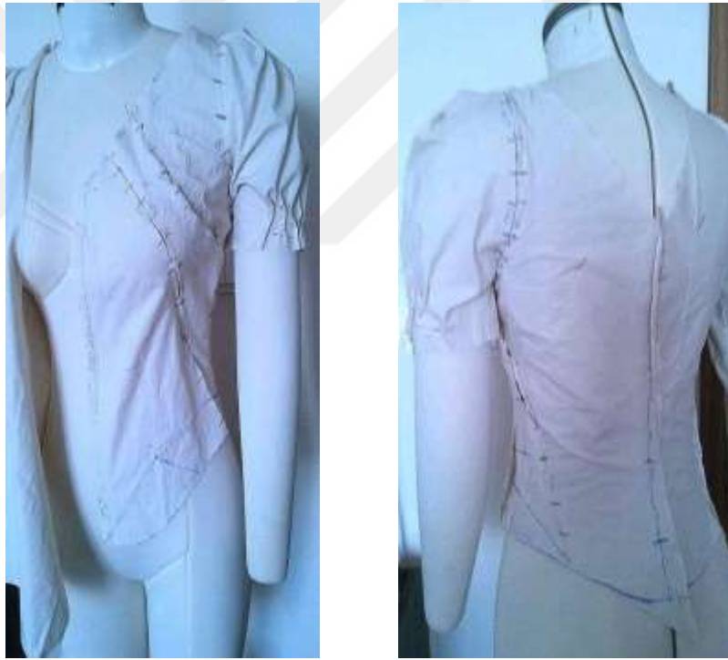
řekil 42. Standart bedene uygun temel kalıplar zerinde giysi formunun oluřturulması, 2021. Kiřisel Arřiv
