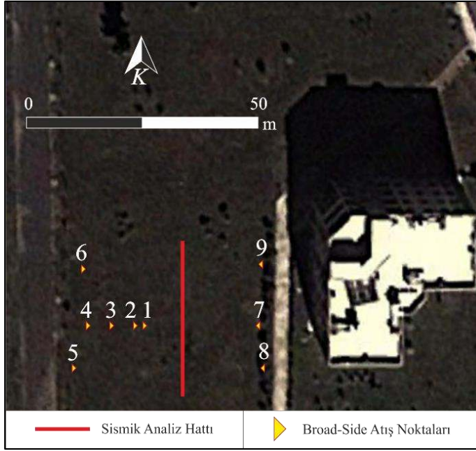
Şekil 4.17. Kampüs alanı 1 numaralı çalışma bölgesinde elektrik özdirenç sonuçlarına göre daraltılmış alanda gerçekleştirilen Broad-Side analizi için atış noktaları
