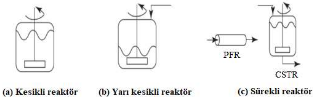
Şekil 2.3. Lateks üretim prosesleri şeması
