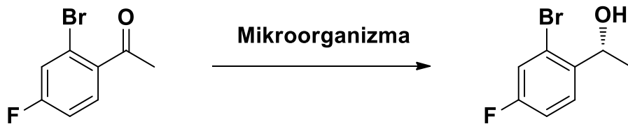
Şekil 20. 2-Bromo-4-floro asetofenon'un asimetrik redüksiyonu.
