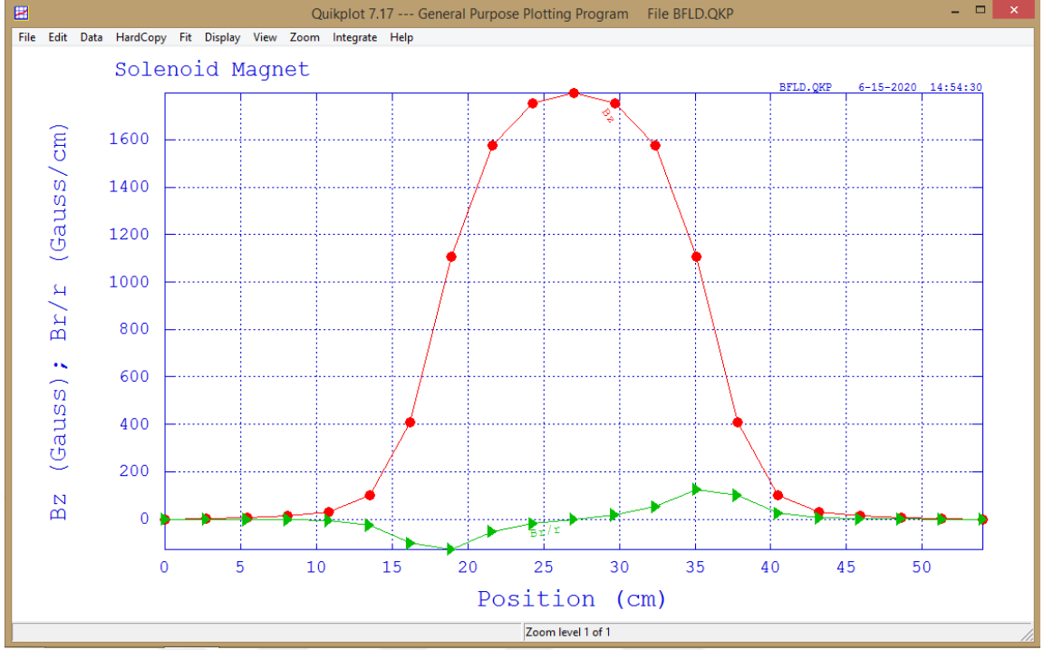
Şekil 3.9: 4000 sarımlı solenoidin manyetik alan profili.
