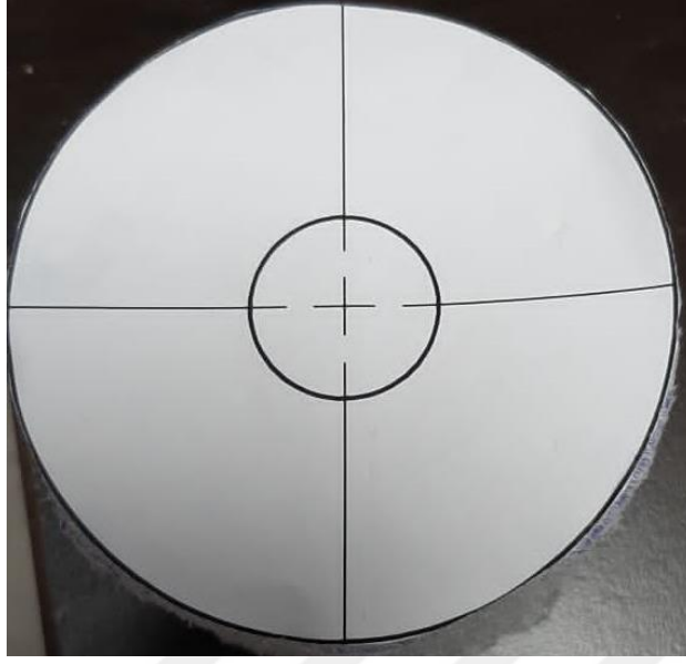
Şekil 3.14: Solenoidin merkezinden manyetik alan ölçümü hizalama yöntemi.
