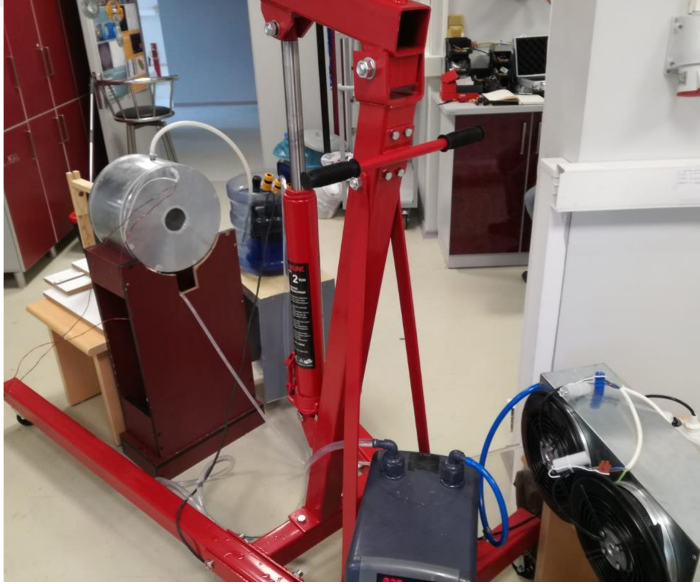
Şekil 3.12: Solenoidin su sızdırmazlık testi.
