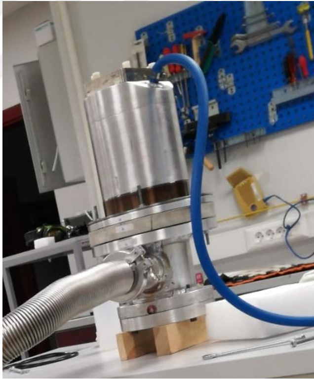
Şekil 3.3: Plazma odası ve iyon sökme sistemi.
