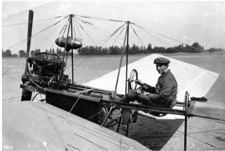
Şekil 53: Fokker’ın Çelik Boru Profil Kullanarak Tasarladığı İlk Uçak: Spin (Örümcek)
