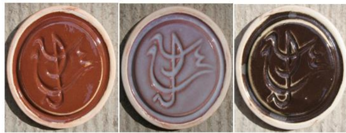
(a) Kurşunlu sır, 1000 °C (b) Alkalili-borlu sır, 1000 °C (c) Alkalili-borlu sır, 1160 °C
