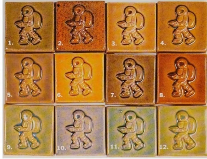
Görsel 2.41. Farklı Pigmentlerin Aynı Sır İçinde Farklı Oranlarda Karıştırılması ile Elde Edilen Renkler 21 (Burlison, 2001, s. 39)
