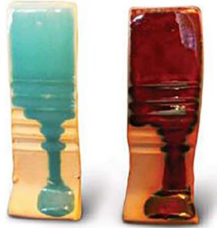
Görsel 2.21. Bakır Karbonat İçerikli Aynı Sırın Yükseltgen (Solda) ve İndirgen (Sağda) Fırın Atmosferinde Pişirimi Sonucu Oluşturduğu Renkler (http-226)
