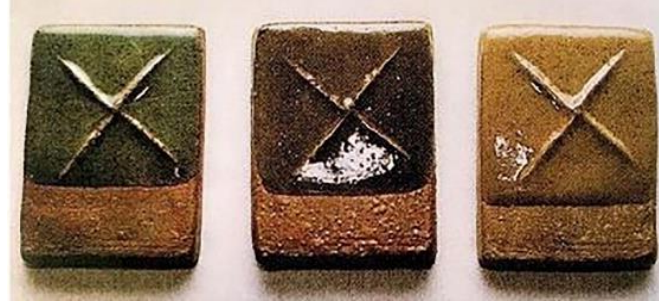
Görsel 2.20. Aynı Seladon Sırrının Yükseltgen, Nötr ve İndirgen Ortamda Pişirilmiş Örnekleri, 1260 °C, (http-224)
