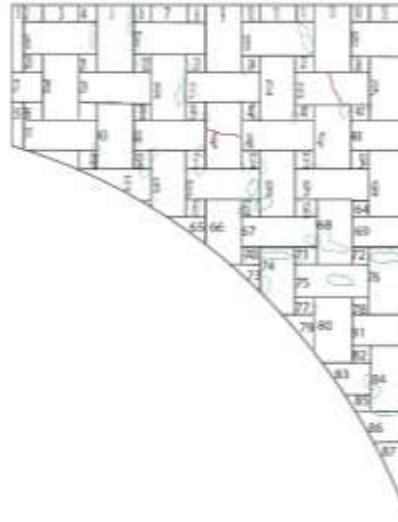
Şekil 25: Pano 30 hasar tespit planı (Koçak, 2021).
