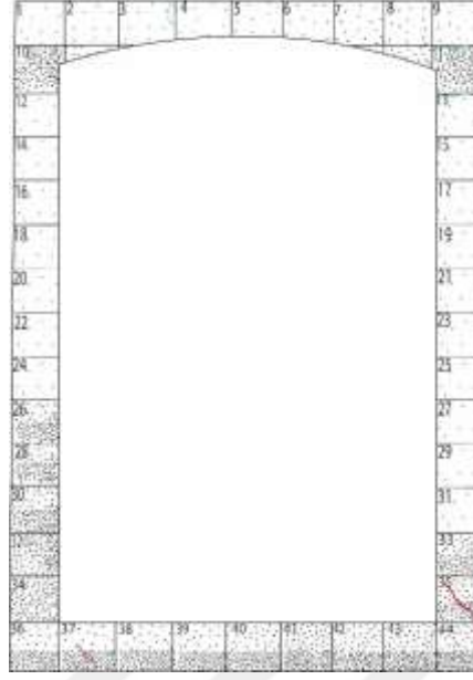
Şekil 46: Pano 52 hasar tespit planı (Koçak, 2021).
