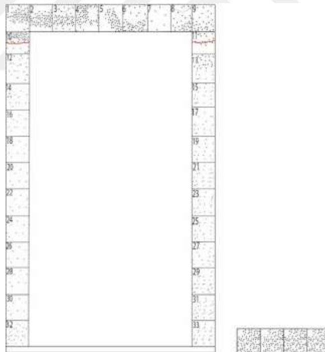
Şekil 80: Pano 91 hasar tespit planı (Koçak, 2021).
