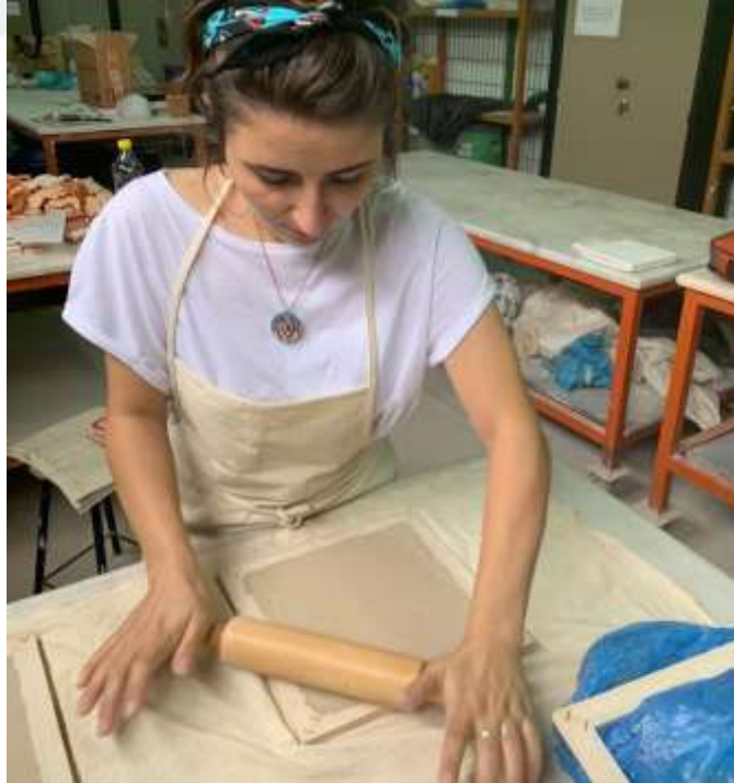
Fotoğraf 218: Ahşap çerçevelere çamur basma, düzeltme (Koçak, 2020).
