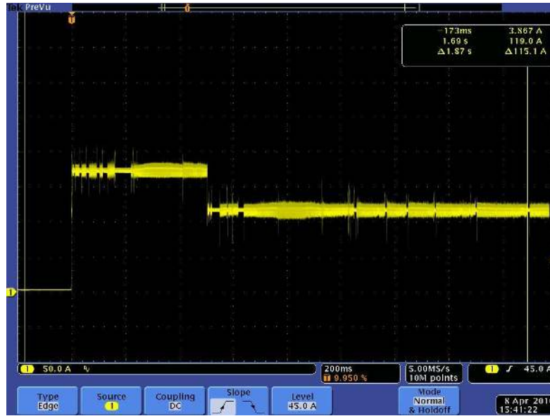
Şekil 7.9 Kaynak işleminde 0.5 s süreli sıcak başlangıç süreci (kaynak akımı)
