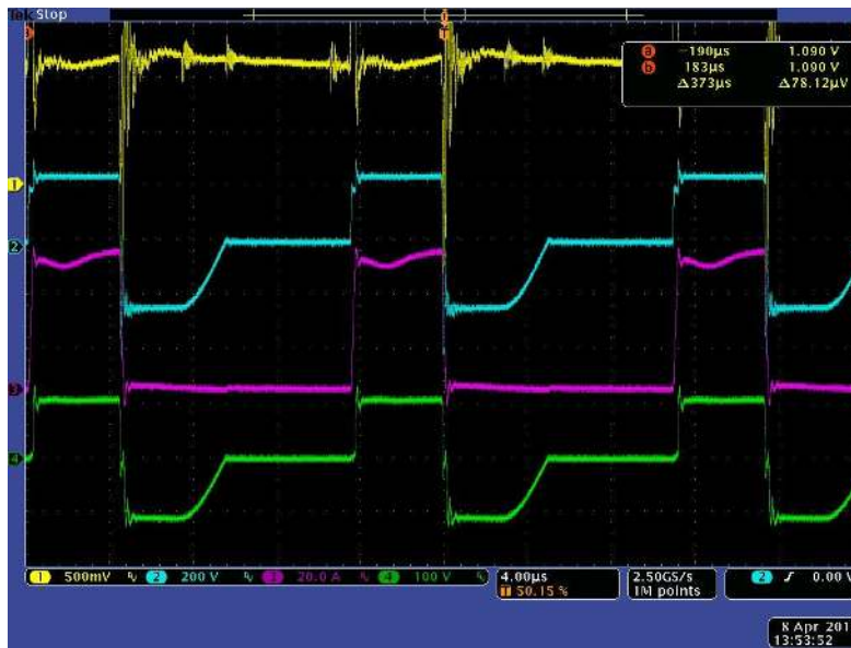
Şekil 7.2 Direnç yükü 200 A. (Yukarıdan aşağıya) a) endüktans akımı, b) primer gerilimi, c) primer akımı, d) sekonder gerilimi
