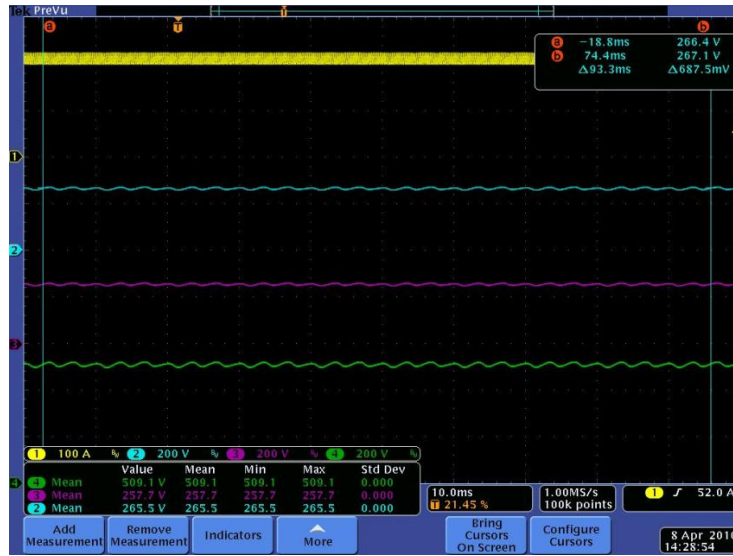
Şekil 7.5 Dönüştürücülerin bara gerilimini paylaşımı. (yukarıdan aşağıya) a) DA bara gerilimi, b) birinci seri kol gerilimi, c) ikinci seri kol gerilimi, d) yük akımı
