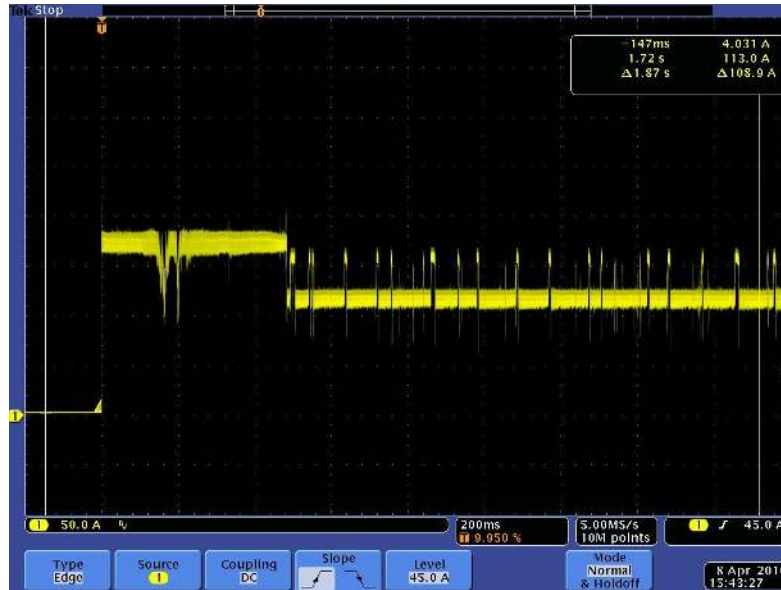
Şekil 7.11 Destekli ark (tam destek) çalışması. 170 A akım darbeleri
