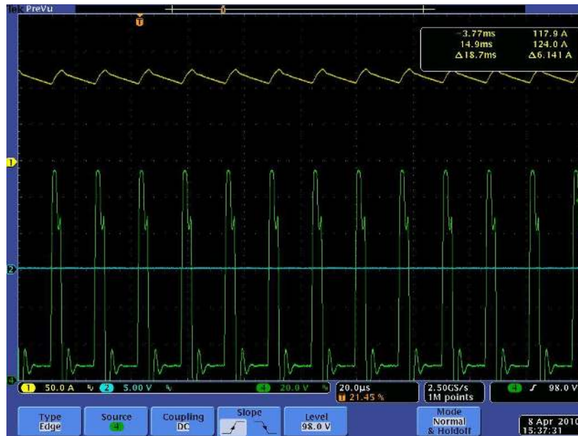
Şekil 7.8 Kaynak işlemi sırasında akım ve gerilimler. A) toplam çıkış akımı, b) ark gerilimi
