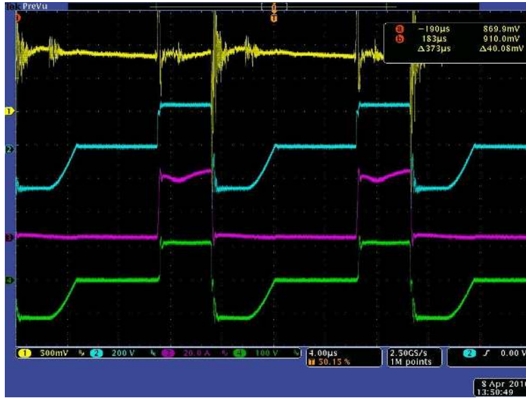
Şekil 7.1 Direnç yükü 150 A. (Yukarıdan aşağıya) a) endüktans akımı, b) primer gerilimi, c) primer akımı, d) sekonder gerilimi
