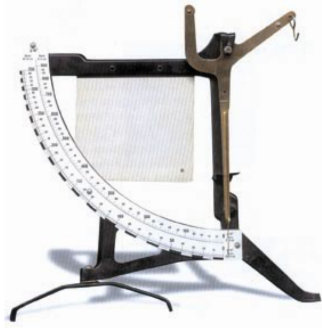
Şekil 3.13. 2. Kâğıt Terazisi. Yukarıdaki alet, gramajı bilinmeyen kağıtlardan alınan 10x10 cm ya da 8x5 cm ebatlarındaki parçalardan gramaj ölçmeye yarayan minik bir kağıt terazisidir.
