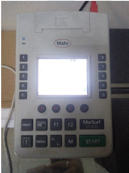
Şekil 4.5. Pürüzlülük ölçüm seti solda kontrol ünitesi MAHRSURF M400 sağda ölçüm ünitesi MAHRSURF D26
