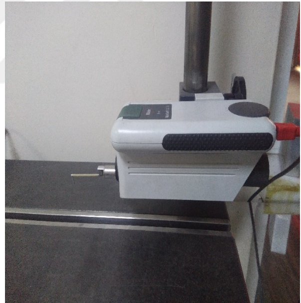
Şekil 4.5. Pürüzlülük ölçüm seti solda kontrol ünitesi MAHRSURF M400 sağda ölçüm ünitesi MAHRSURF D26
