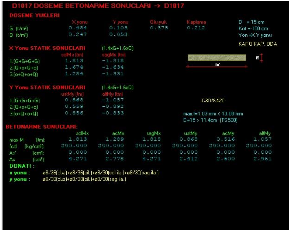
Şekil 3.23 Döşemelere Gelen Moment Ve Kullanılan Donatılar
