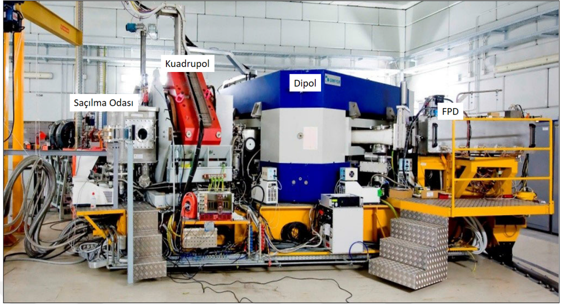
Şekil 3.1. MAGNEX spektrometresinin genel görünümü. Soldan sağa, saçılma odası, kuadrupol (kırmızı) ve dipol (mavi) mıknatıslar ve Odak Düzlemi Detektörü (FPD) görülebilir (Cappuzello vd. 2016)
