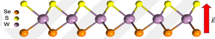
Şekil 1.5. Janus WSeS yapısı ve Se düzleminden S düzlemine yönelen elektrik alan gösterimi.
