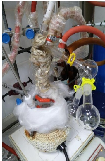
Şekil 3.7. 2-metil-1 H -pirol(63) sentezi destilat düzeneği
