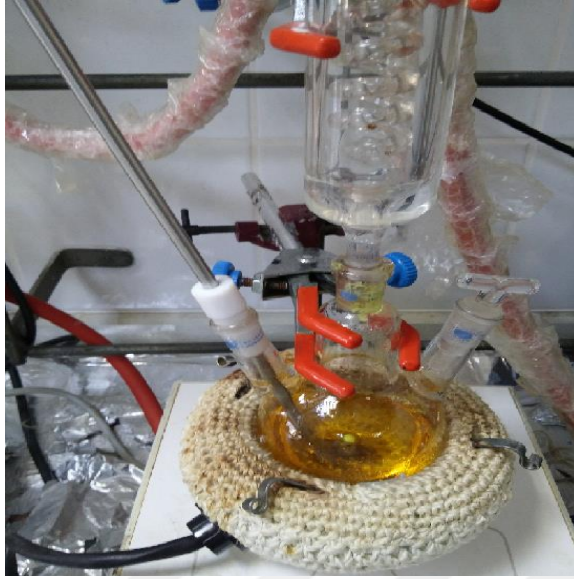
Şekil 3.6. 2-metil-1 H -pirol(63) sentezi reflüks düzeneği
