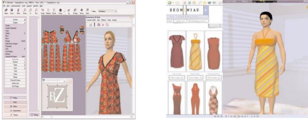
Şekil 3.3. Gerber programında kalıp hazırlama.
