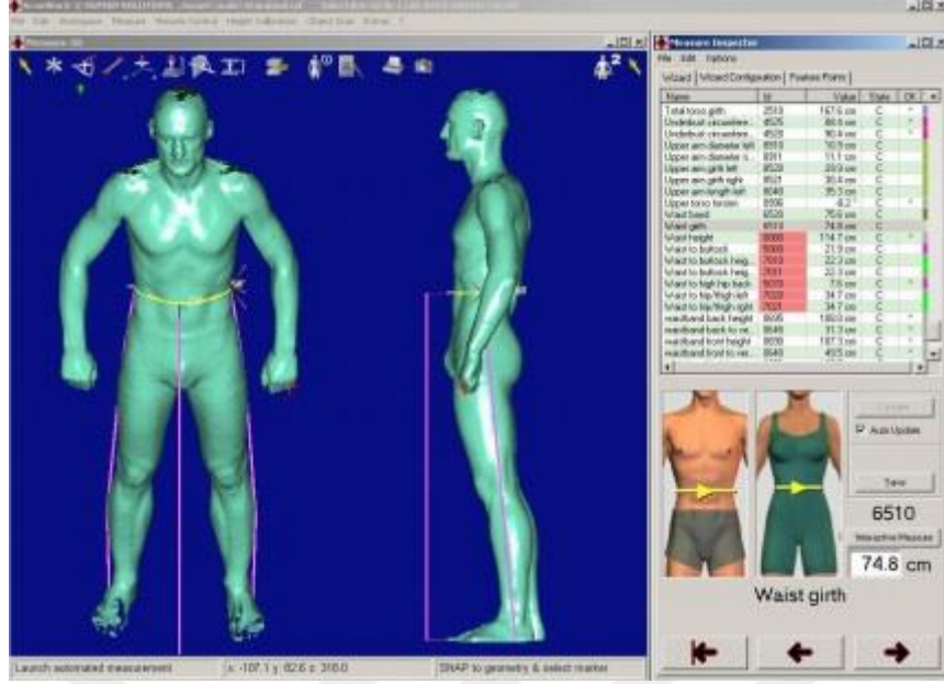
Resim 3.5. Anthroscan ile kullanılan ScanWorks programında vücut ölçülendirilmesi.
