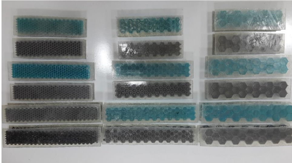
Şekil 4.4. Katılaşma süreci tamamlanan ve tel testere yardımı ile temizlenen üç nokta eğilme deneyi numuneleri
