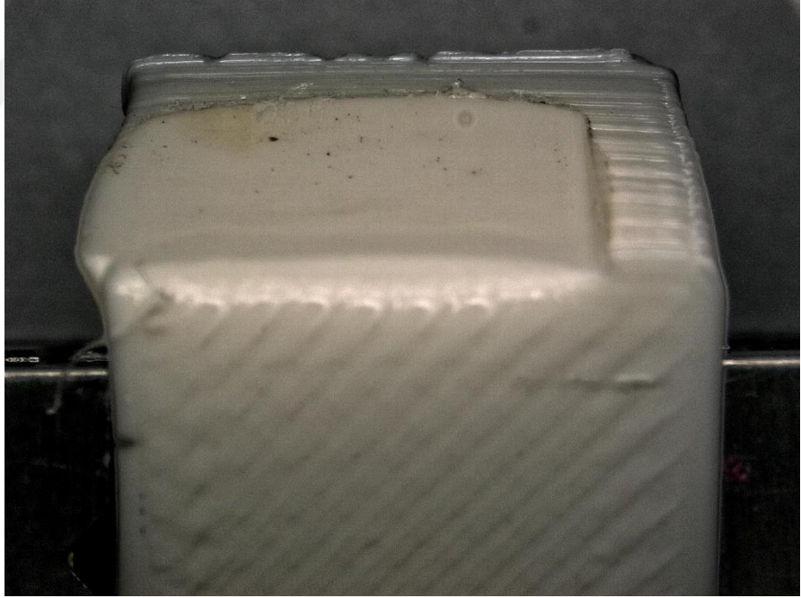
Şekil 6.22 White Nylon 2 aşınma yüzeyinin paralel yönden görünüşü
