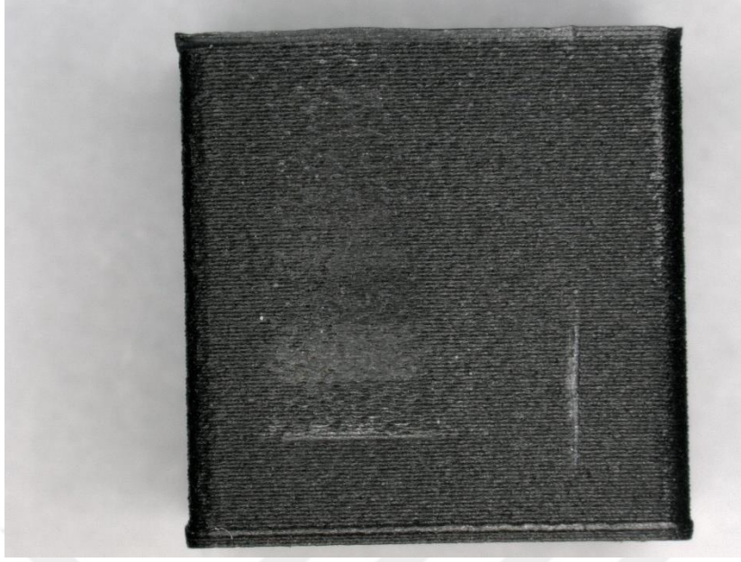
Şekil 6.35 ONYX-FR 13 aşınma yüzeyinin dik yönden görünüşü
