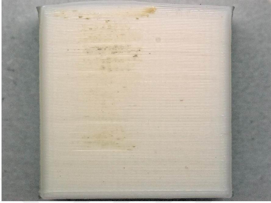
Şekil 6.19 White Nylon 1 aşınma yüzeyinin dik yönden görünüşü
