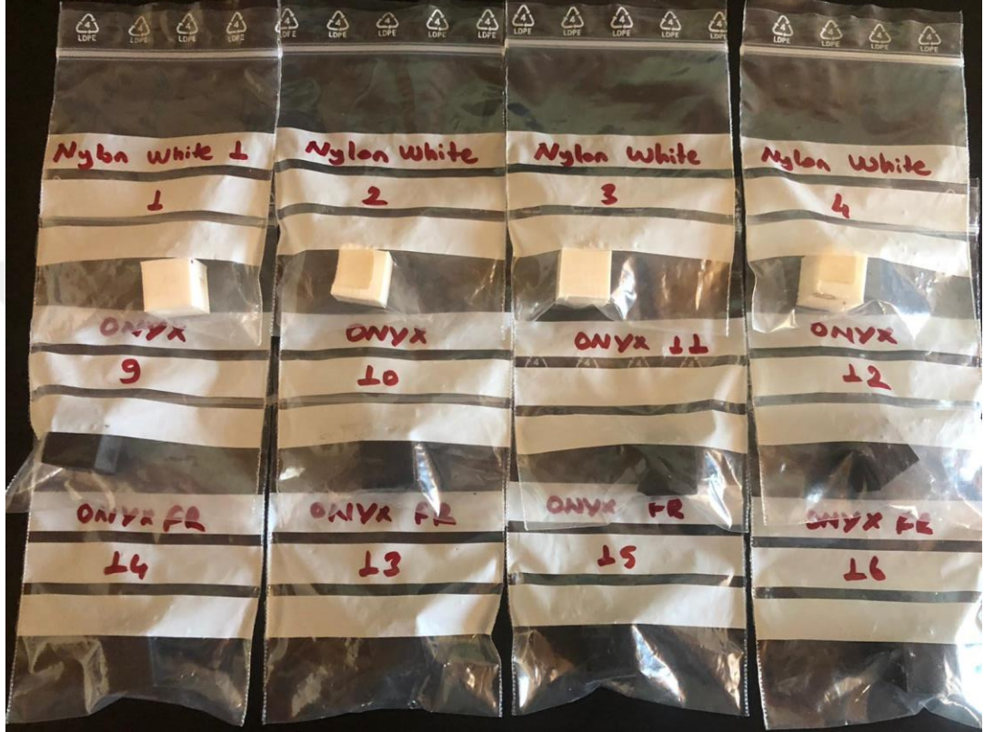
Şekil 6.9 Üretilen tüm polymer malzemelerin 12,7x12,7x12,7 mm'lik küpler şeklinde elde edilmesi ve kilitli poşetlerle muhafaza edilmesi.
