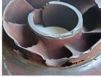
Şekil 4.6 Bir santrifüj pompada kaviteasyon sonucu oluşan aşınma. (Wikiwand)
