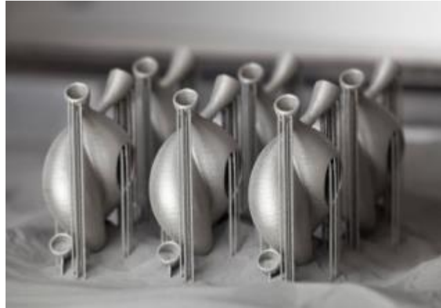
Şekil 5.6 Katmanlı üretim teknolojisi ile batch halinde üretilen numuneler (E&M Magazine-N. Kara)
