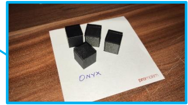
Şekil 6.6 Markforged® Two ONYX Numune Üretimi (PROMAKİM)
