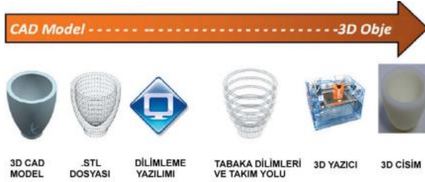
Şekil 5.3 Katmanlı üretim proses süreci (E&M Magazine-N. Kara)
