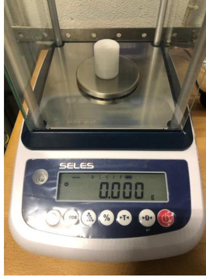
Şekil 6.12 Ağırlık kaybı ölçümlerinin yapıldığı hassas ölçüm cihazı
