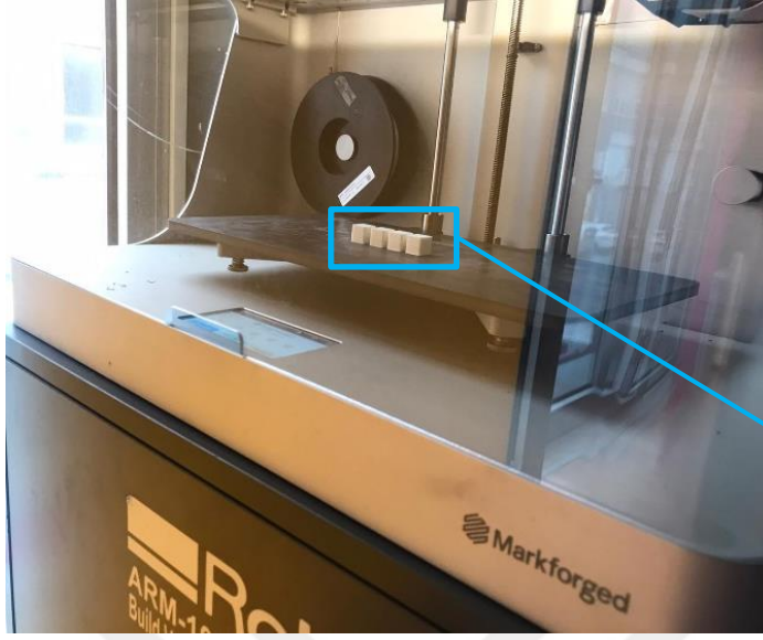
Şekil 6.5 Markforged® Two Nylon White Numune Üretimi (PROMAKİM)
