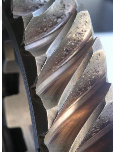
Şekil 4.5 Sonsuz vida karşı çarkında meydana gelen yorulma aşınması (Triboloji 2013, Wikipedia).
