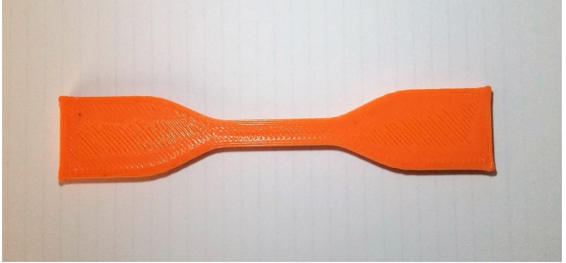
Fotoğraf 4.1. ASTM D638 Type 4 çekme testi numunesi
