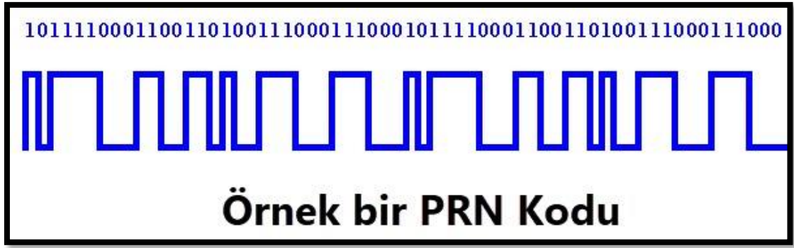
Şekil 4.2 Uydularda oluşturulan bir PRN kod örneği
