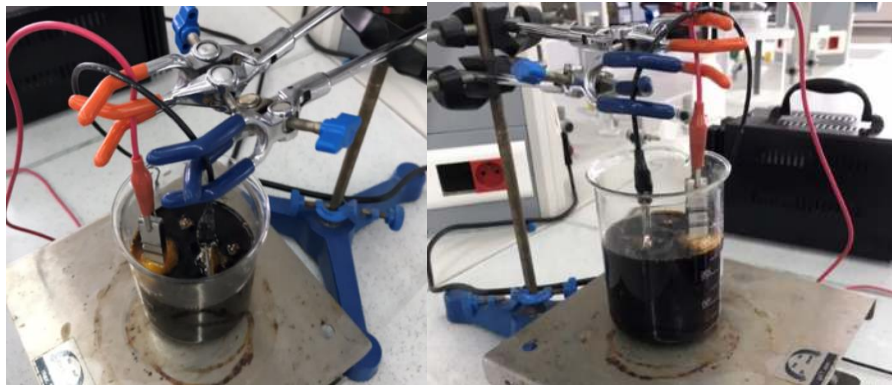
Şekil 19 Dağlama İşleminin Yapımı ve Düzeneği
