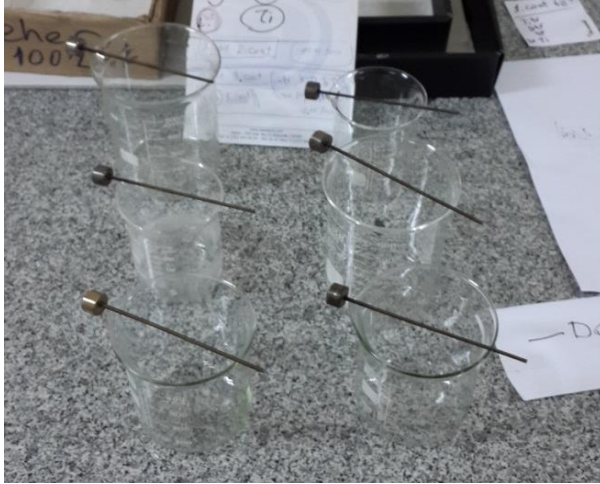
Şekil 14: Sol-jel yöntemiyle kaplanmış numuneler
