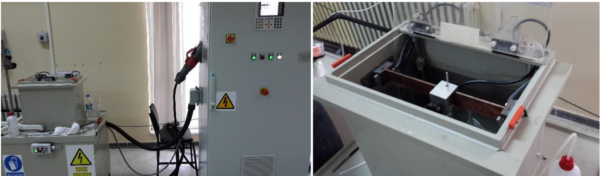
Şekil 20: MAO işleminin yapıldığı deney düzeneği
