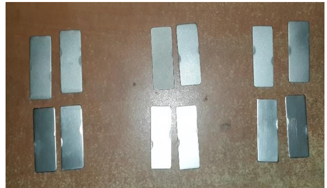
Şekil 18: CAPVD ile kaplanmış kumlu ve kumsuz numuneler
