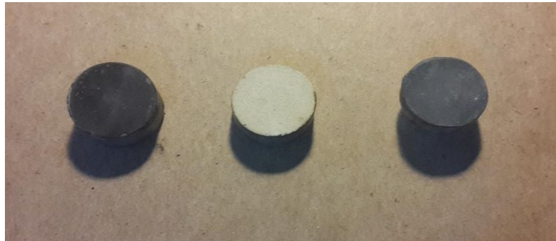
Şekil 13: Plazma püskürtme ve MAO yöntemiyle kaplanmış numuneler
