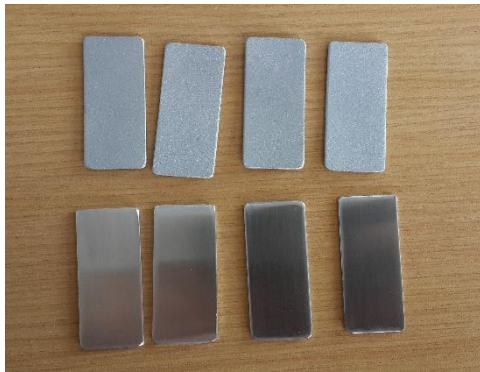
Şekil 17: CAPVD ile kaplanmamış kumlu ve kumsuz numuneler
