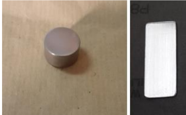
Şekil 16: CAPVD kaplama yönteminde kullanılan silindir ve plaka şeklindeki numuneler
