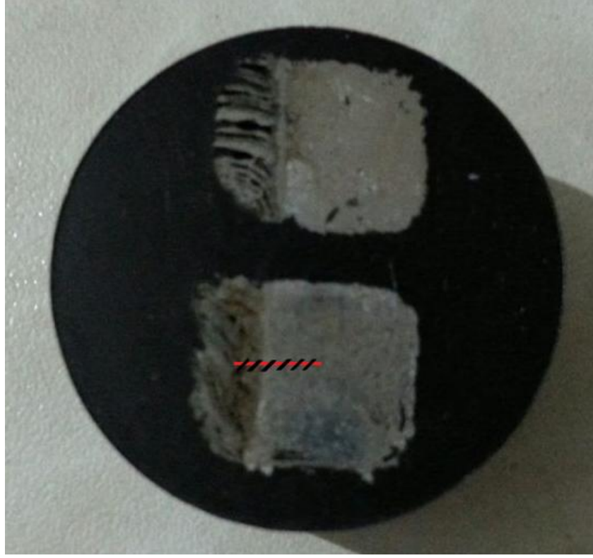
Şekil 3.5. Numune üzerinde alınan mikrosertlik ölçüm noktaları
