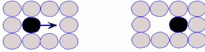
Şekil 2.10. Boşluk veya yeralan atom difüzyonu [1].
