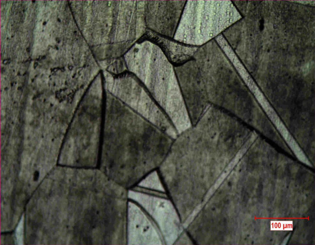
Şekil 4.8. Optik mikroskoptaki 316L paslanmaz çeliğin x200 büyütmedeki görüntüsü
