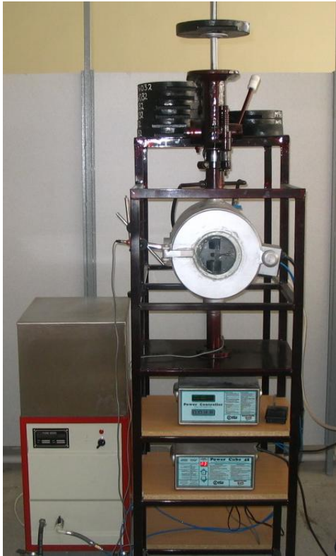
Şekil 3.2. Difüzyon kaynak düzeneğinin şematik görüntüsü [54]
