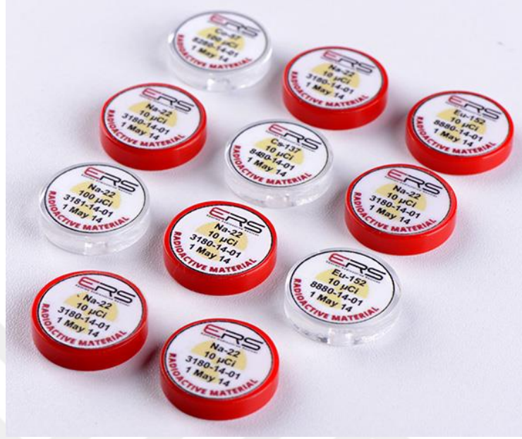
Şekil 5.2: Kalibrasyon için yaygın olarak kullanılan radyoaktif materyaller.
