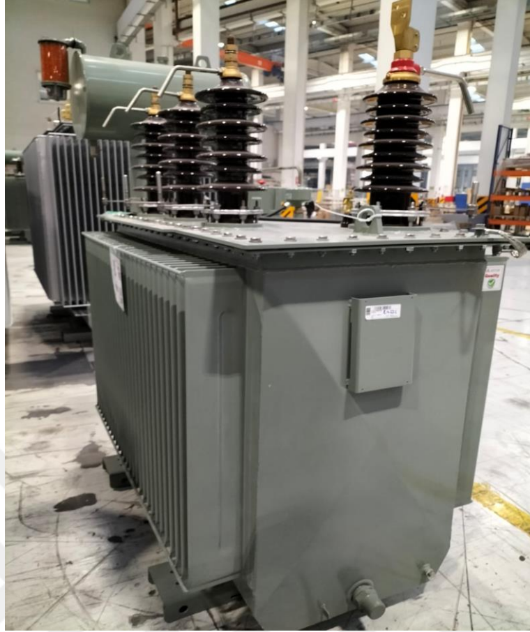
Şekil 4.5. Zig-zag Topraklam Transformatörün Nihai Görünümü
