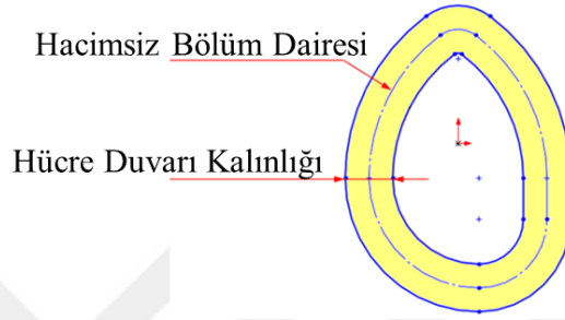
Şekil 3.22 Hücre duvarı kalınlığı verilerek hacim kazandırılmış hücre geometrisi.
