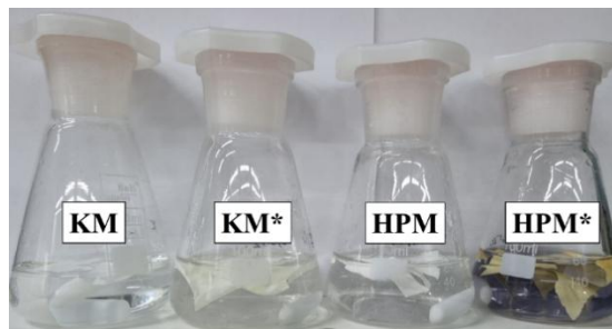
Şekil 3.8: İyodometrik titrasyon testi sırasında membranların görsel karşılaştırması (Soldan sağa: KM, KM, HPM ve HPM*).
