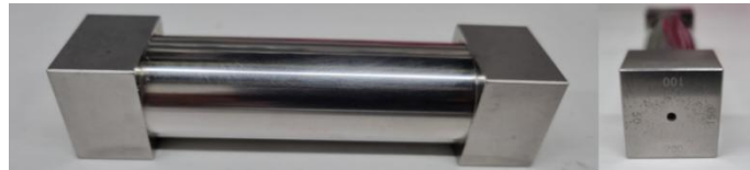
Şekil 2.3: Farklı film kalınlıklarını (50, 100, 150, 200 µm) ayarlamak için kullanılan dört taraflı film aplikatörü.
