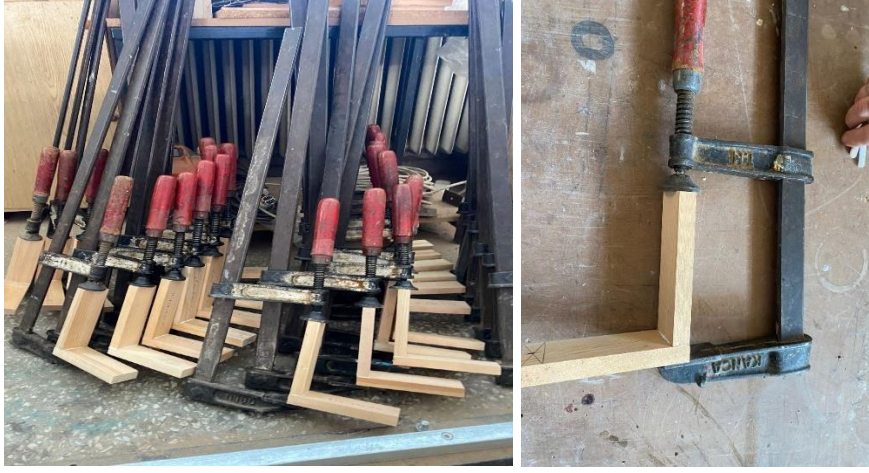
Şekil 12. İşkence ile yapışmaya tabi tutulmuş kavelalı birleşme yerleri
