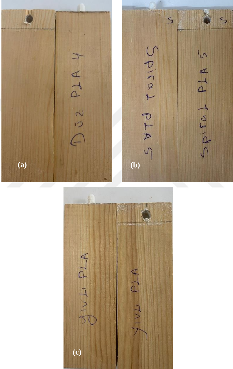
Şekil 14. PLA'dan üretilmiş a) Düz, b) Spiral, c) Yivli desenli kavelalı birleştirmeler
