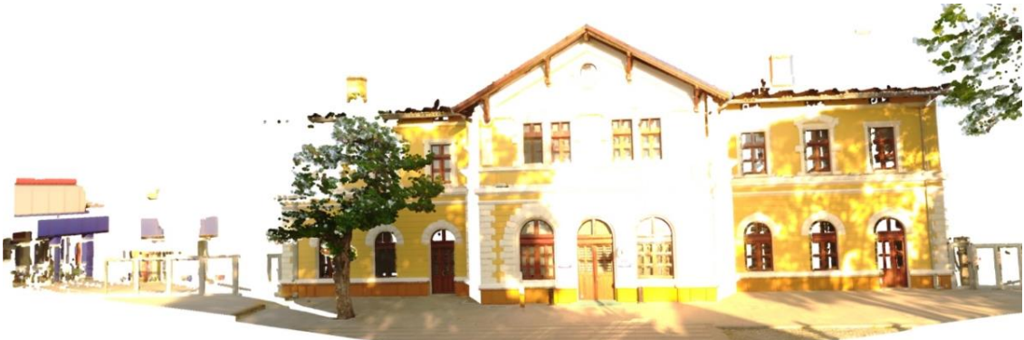
Şekil 3.24. Tren Garı nokta bulutunun taramadan gelen ham hali
