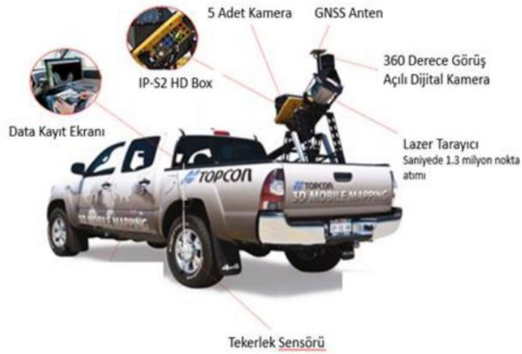
Şekil 4.3 Mobil lazer tarama sistemi bileşenleri (Polat ve Uysal 2016)
