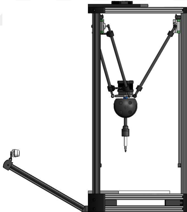
Şekil 4.13 : Intel derinlik kamerasının robota montajının yandan görünümü [42].
