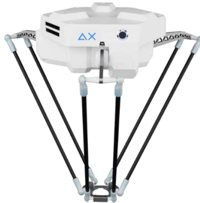
Şekil 2.3 : Döner eklemlili 3 eksen delta robot [23].
