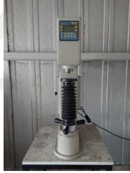
Şekil 3.7. DİĞİROCK-RB profesyonel sertlik ölçüm makinesi
