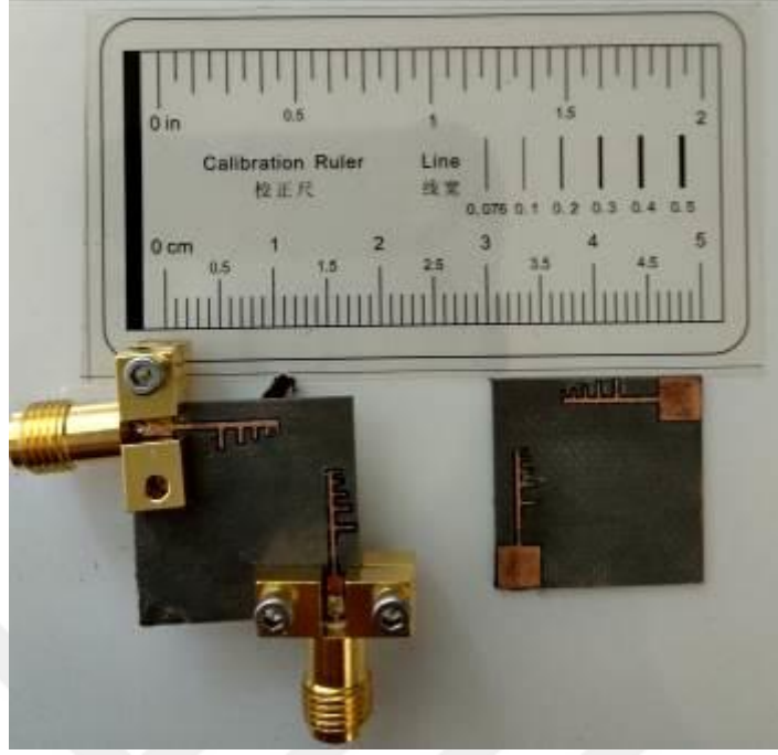
Şekil 4.23 LPDA MIMO anten prototip fotoğrafı
