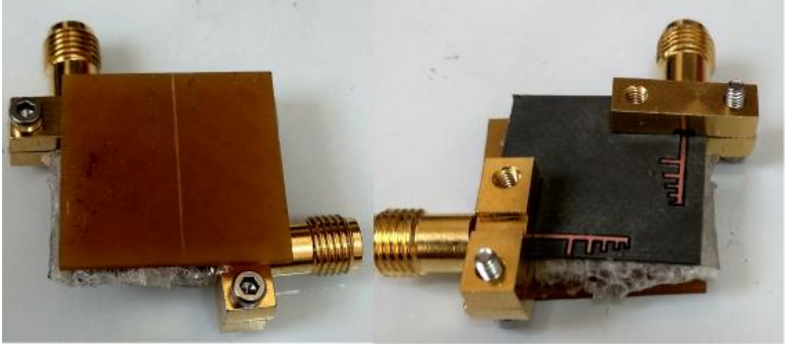
Şekil 4.25 Üst katmanlı LPDA MIMO anten prototip resmi
