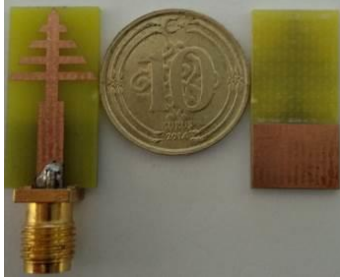
Şekil 4.2 Üçgen şekilli LPMA monopol anten prototipi
