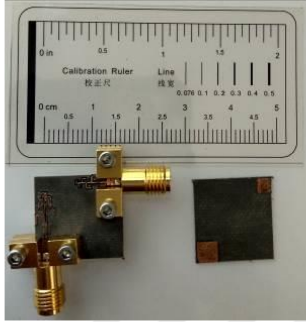
Şekil 4.52 Çift bant ÇLPMA MIMO anten prototipi
