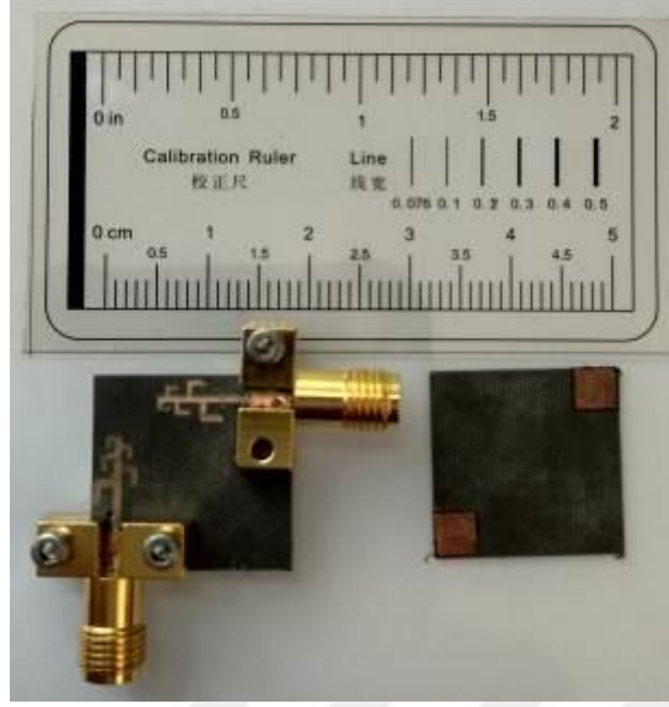
Şekil 4.34 Tek bant ÇLPMA MIMO anten prototipi
