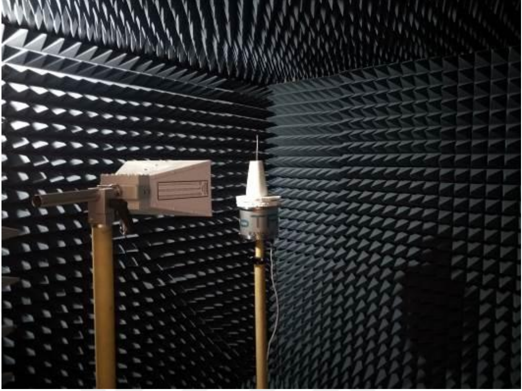
Şekil 3.12 KMU MAMAR laboratuvarında bulunan yarı-yansısız oda
