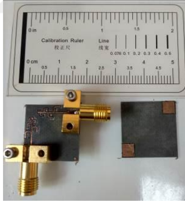
Şekil 4.43 Genişbant ÇLPMA MIMO anten prototipi
