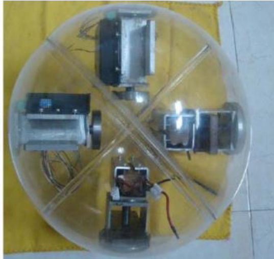
Şekil 2.5 Joshi küresel robot (Joshi ve Banavar 2009).
