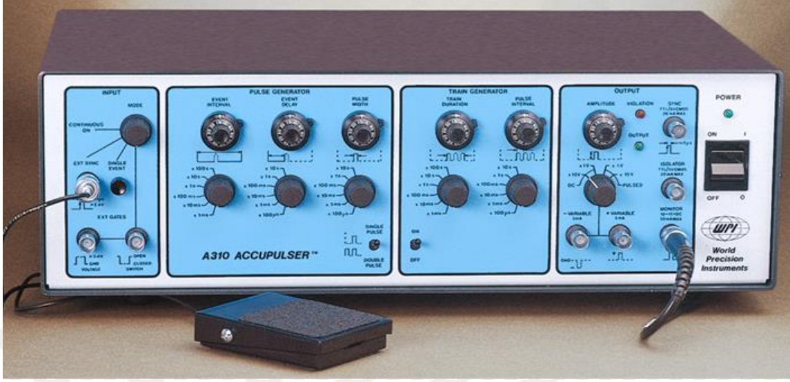
Şekil 3.3DBS için kullanılan stimülatör
