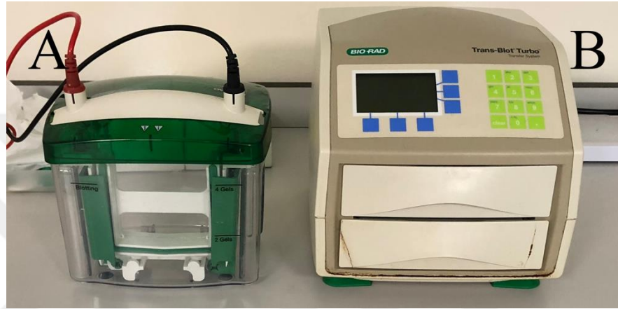
Şekil 3.25: A) Dikey elektroforez. B) Transfer cihazı
