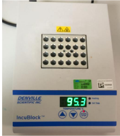
Şekil 3.22: Proteinlerin ısıtılarak denatüre edilmesinde kullanılan inkübasyon cihazı
