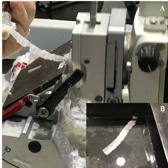
Şekil 3.14: Mikrotom ile kesit alınma işlemi
