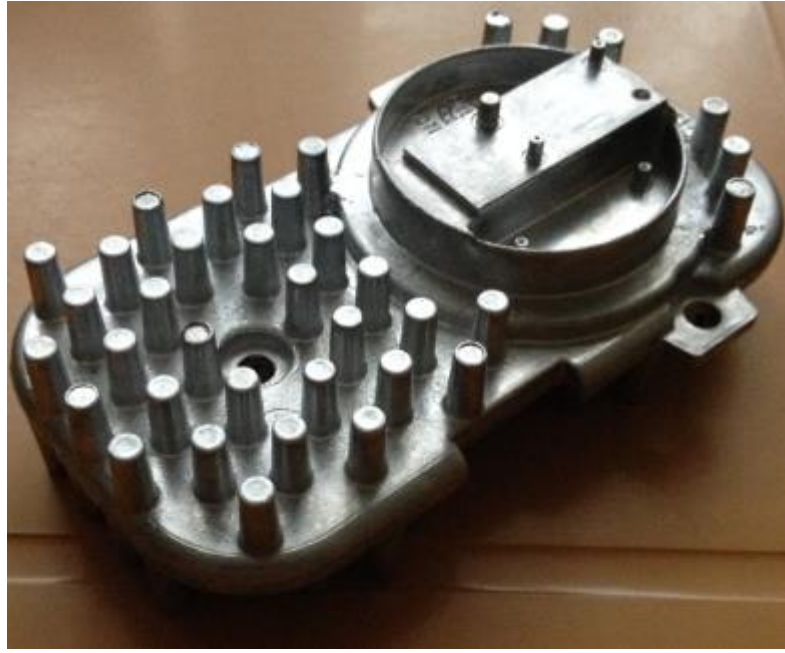
Şekil 4.9: Pürüzlülük ölçümü yapılacak iş parçası(Soğutucu).
