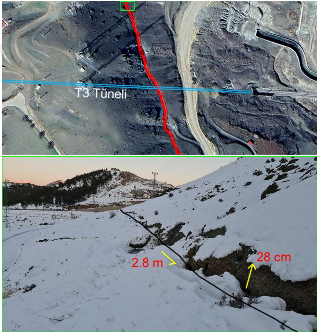
Şekil 3.4. T3 Tüneli Google Earth üzerinde fay kırığının konumu ve fayda gelişen atım miktarları.
