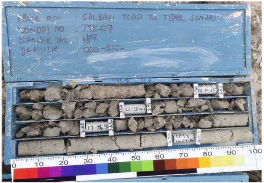
Şekil 3.6. TSK-07 kuyusuna ait kumlu çakıllı kil numuneleri.
