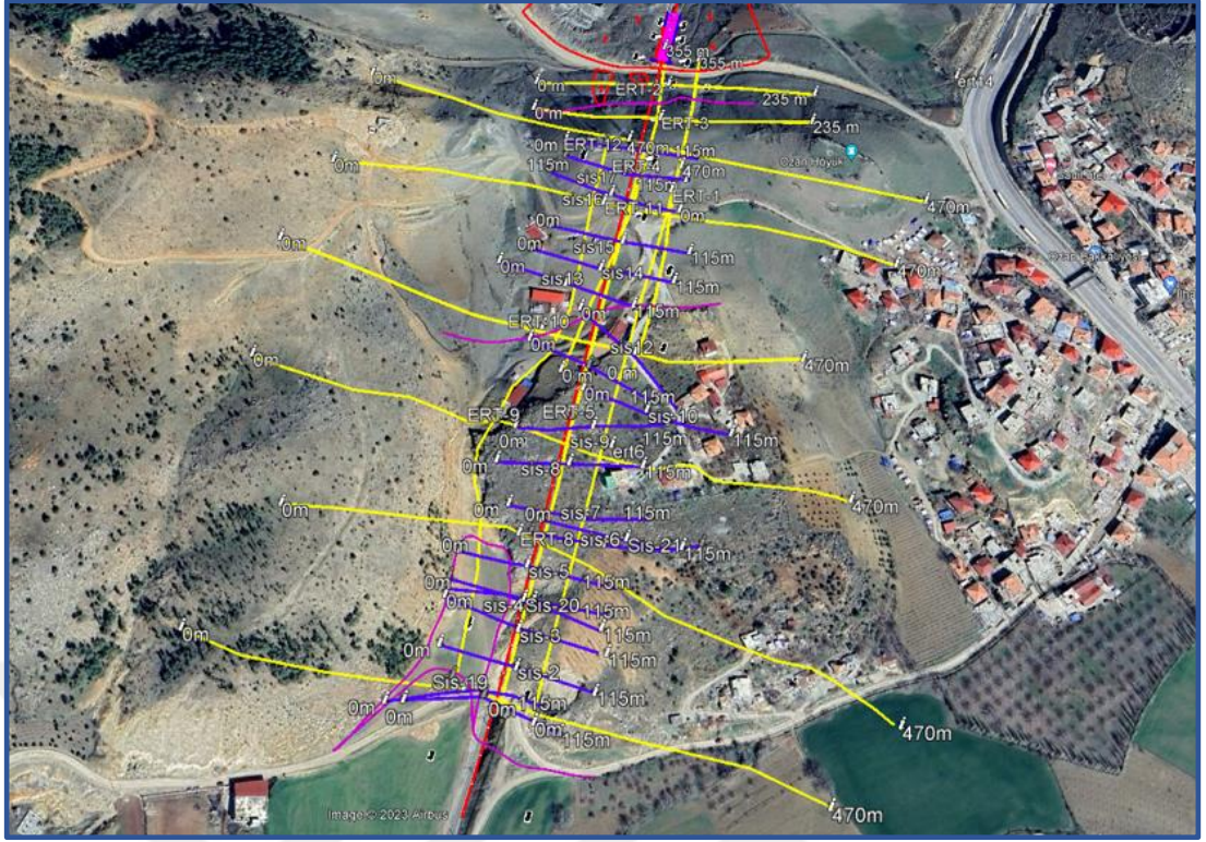
Şekil 3.10. Çalışma sahasında uygulanan jeofizik etüt profilleri (sarı çizgiler ERT, mavi çizgiler sismik yansıma, kırmızı çizgiler heyelanları, pembe çizgiler birim sınırlarını göstermektedir).
