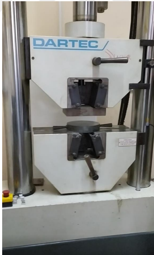
Şekil 4.3. 600kN kapasiteli servohidrolik kontrollü Dartec çekme makinası
