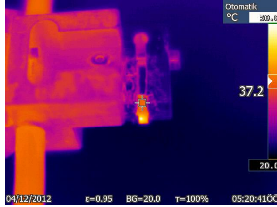
Şekil 144. %6 Katkılı 3-mm uzunluğundaki Tm:YAG lazer sistemin kristal su sıcaklığı 37.5 °C iken krisral üzerindeki sıcaklığın portatif termal kamera ölçümü ile alınan görüntüsü (termal kamera ile ölçülen değer 37,2 °C)
