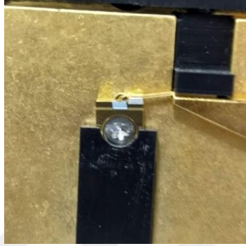
Şekil 13. Daralan kılavuz yapılı lazer diyotların görüntüsü
