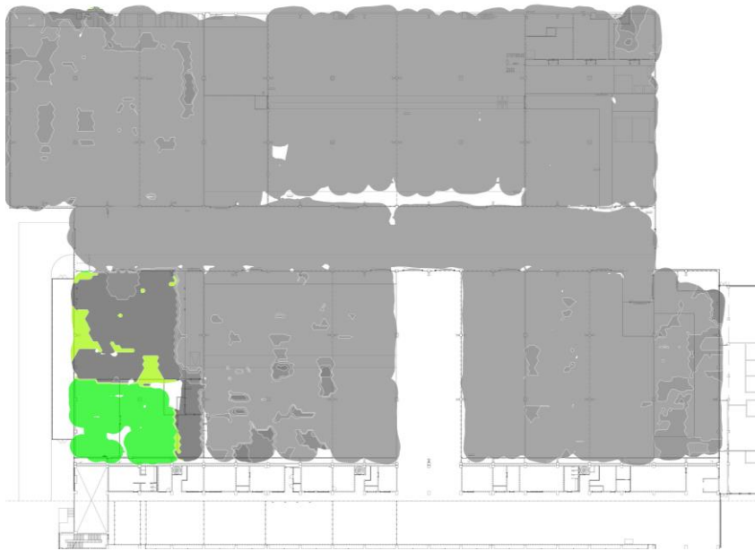
Şekil 4.31. A blok zemin kat 2.4 GHz frekans bandı kanal çakışması ısı haritası.
