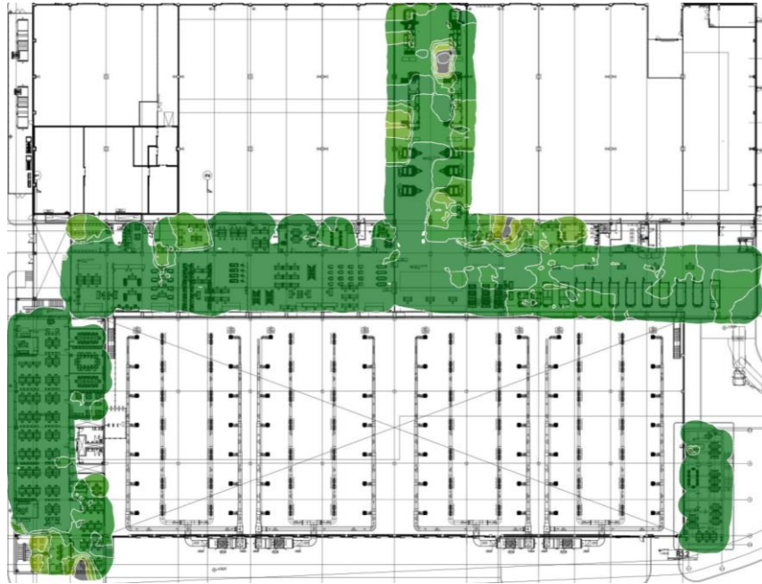
Şekil 4.17. B ve C blok 1.kat 2.4 GHz frekans bandı SNR ısı haritası.
