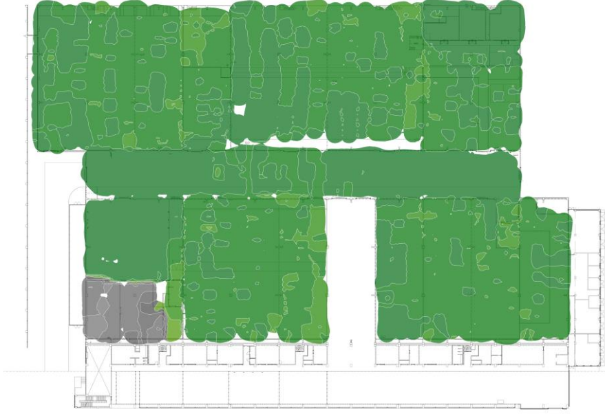
Şekil 4.14. A blok zemin kat 5 GHz frekans bandı SNR ısı haritası.
