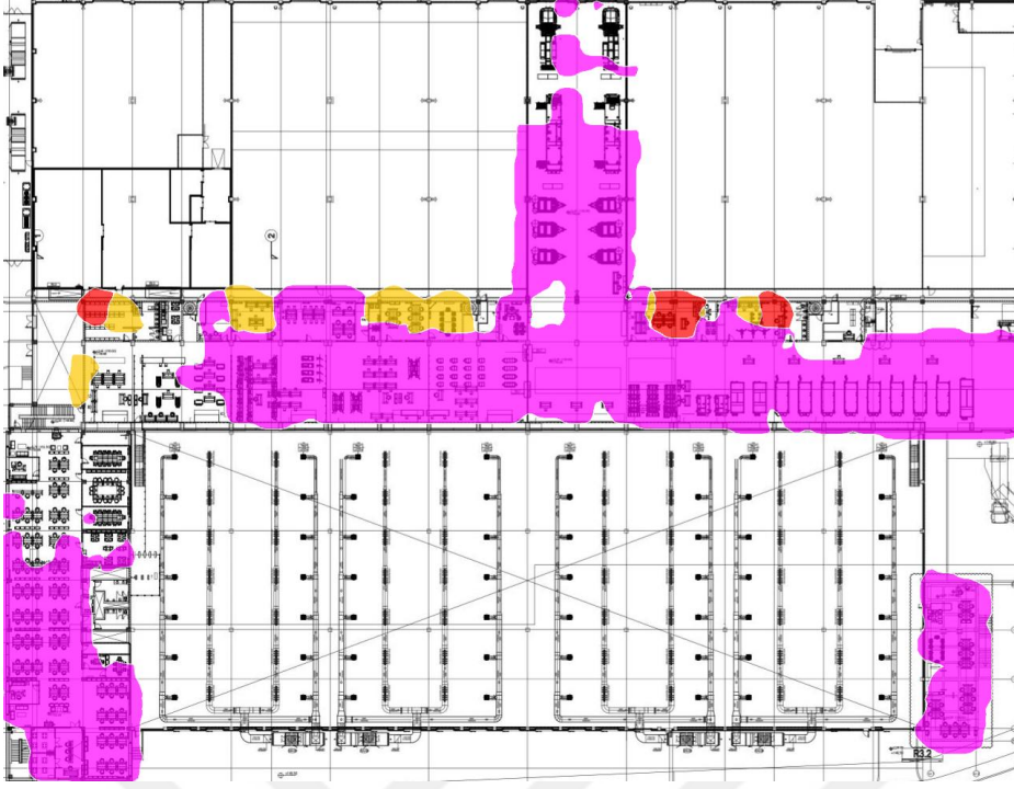
Şekil 4.39. B ve C blok 1.kat 5 GHz frekans bandı genel ağ performansı ısı haritası.
