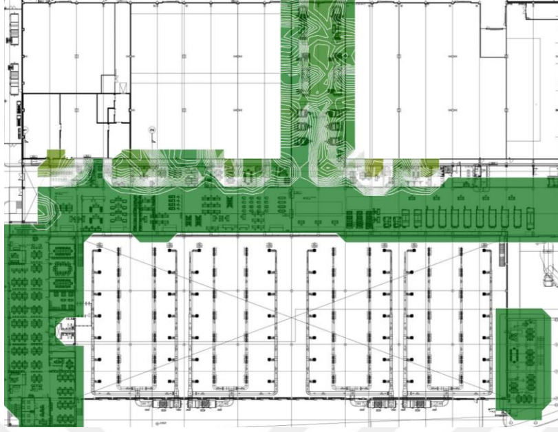
Şekil 4.30. B ve C blok 1.kat 5 GHz frekans bandı ağ kapasitesi ısı haritası.
