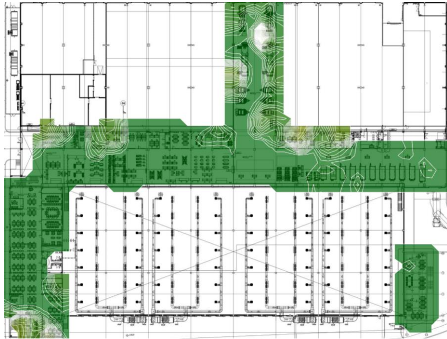
Şekil 4.29. B ve C blok 1.kat 2.4 GHz frekans bandı ağ kapasitesi ısı haritası.
