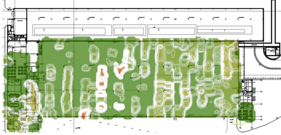
Şekil 4.27. B ve C blok zemin kat 2.4 GHz frekans bandı ağ kapasitesi ısı haritası.
