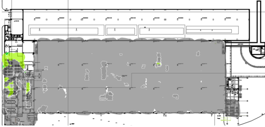
Şekil 4.33. B ve C blok zemin kat 2.4 GHz frekans bandı kanal çakışması ısı haritası.
