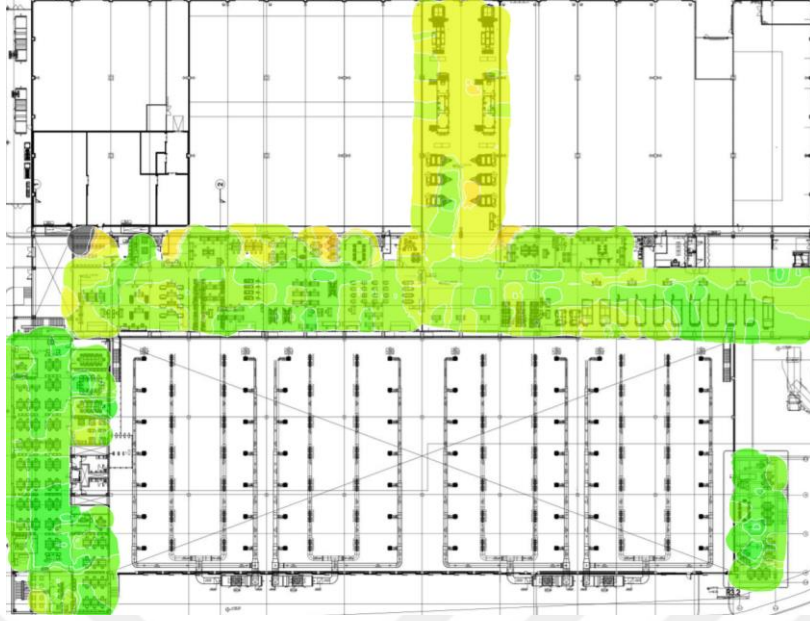
Şekil 5.2. B ve C blok 1.kat sinyal gücü iyileştirme sonucu.
