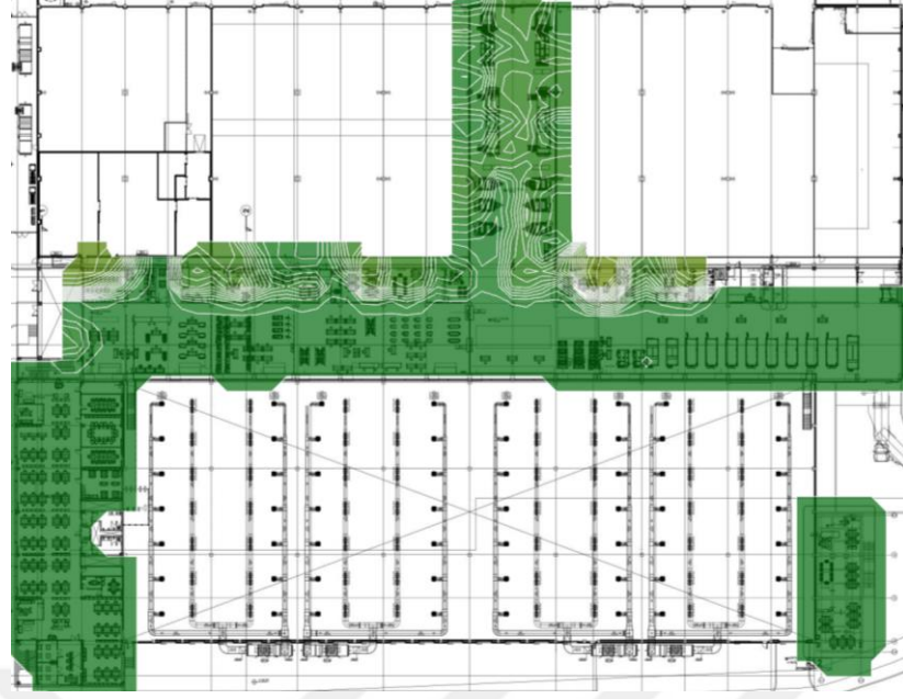
Şekil 4.24. B ve C blok 1.kat 5 GHz frekans bandı veri hızı ısı haritası.
