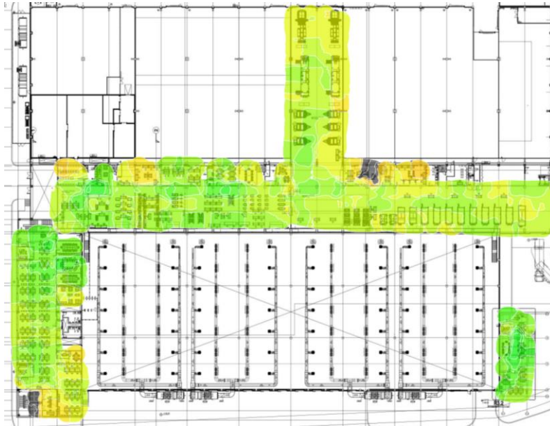
Şekil 4.5. B ve C blok 1.kat 2.4 GHz frekans bandı sinyal gücü haritası.
