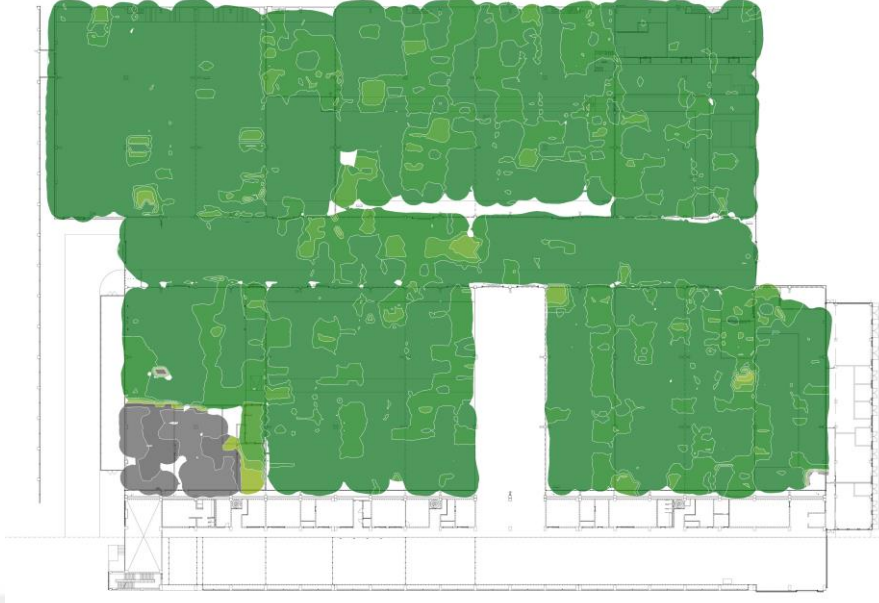
Şekil 4.13. A blok zemin kat 2.4 GHz frekans bandı SNR ısı haritası.
