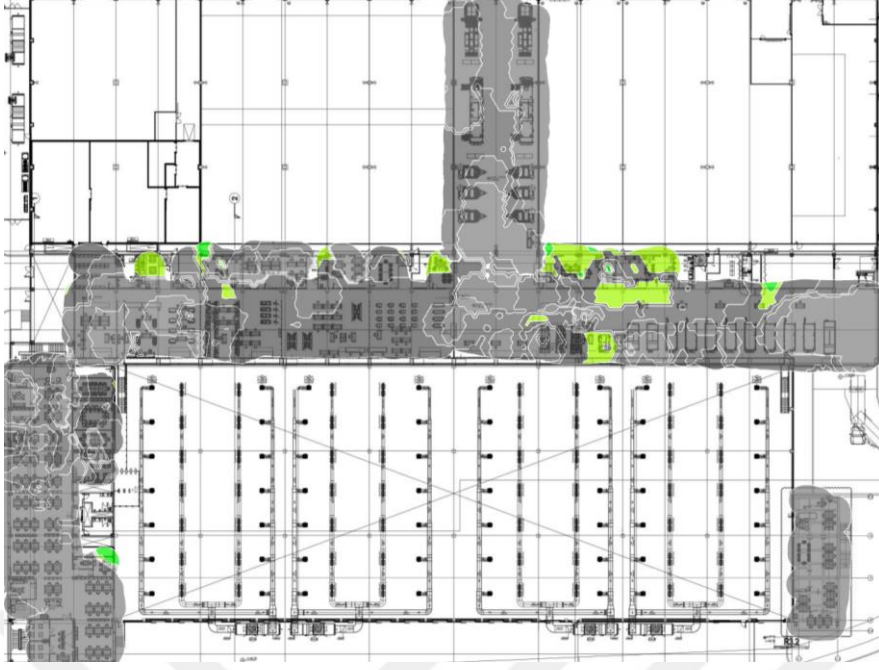
Şekil 4.35. B ve C blok 1.kat 2.4 GHz frekans bandı kanal çakışması ısı haritası.
