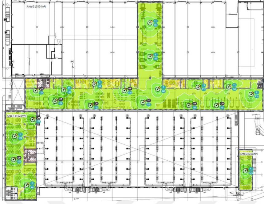
Şekil 3.6. B ve C blok 1. kat otomatik planlayıcı sonucu.
