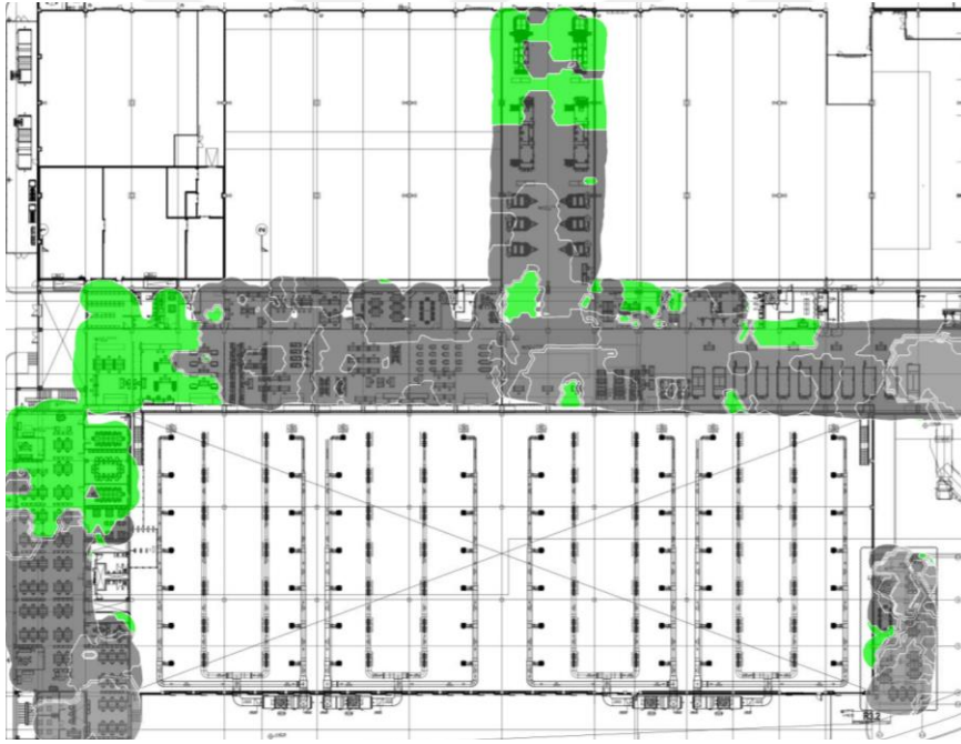
Şekil 4.36. B ve C blok 1.kat 5 GHz frekans bandı kanal çakışması ısı haritası.
