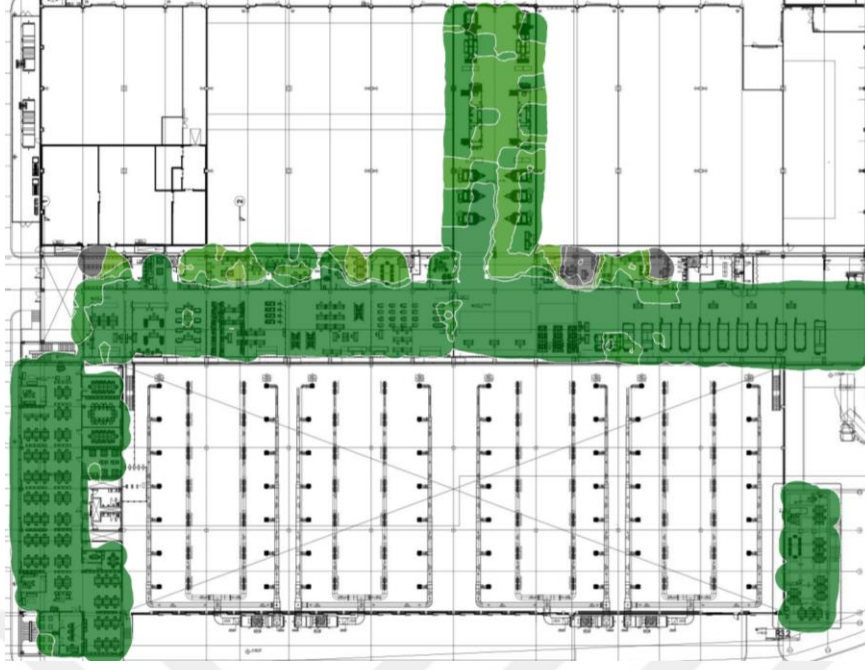
Şekil 4.18. B ve C blok 1.kat 5 GHz frekans bandı SNR ısı haritası.
