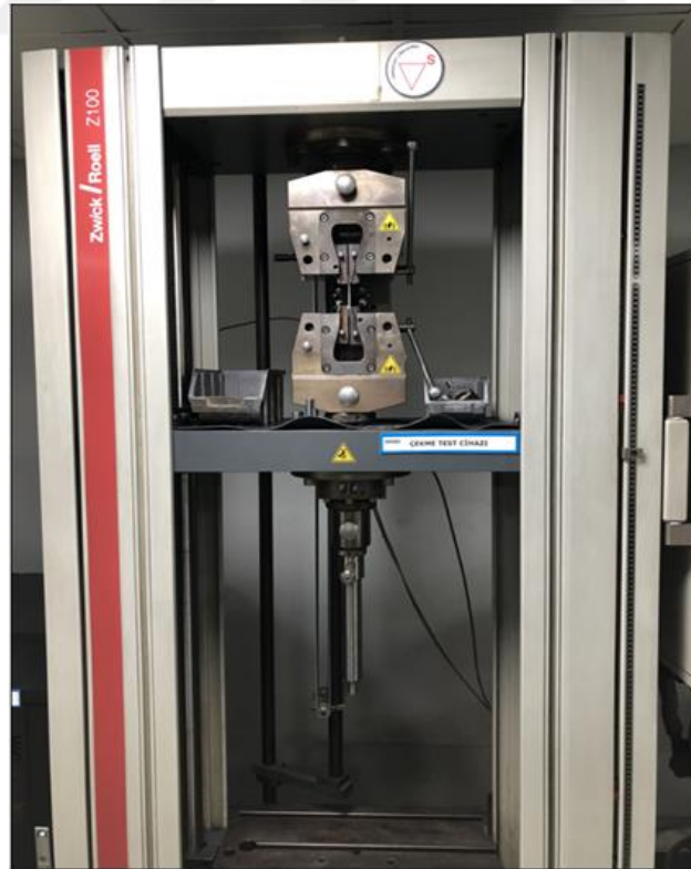
Şekil 22: Çekme Testi Örnek Fotoğraf Görüntüsü
