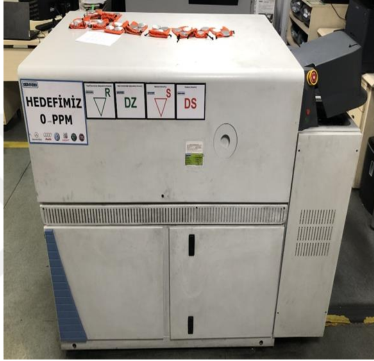
Şekil 14: Numunelerinin Kimyasal Bileşiminin Belirlendiği Spektrometre Cihazı
