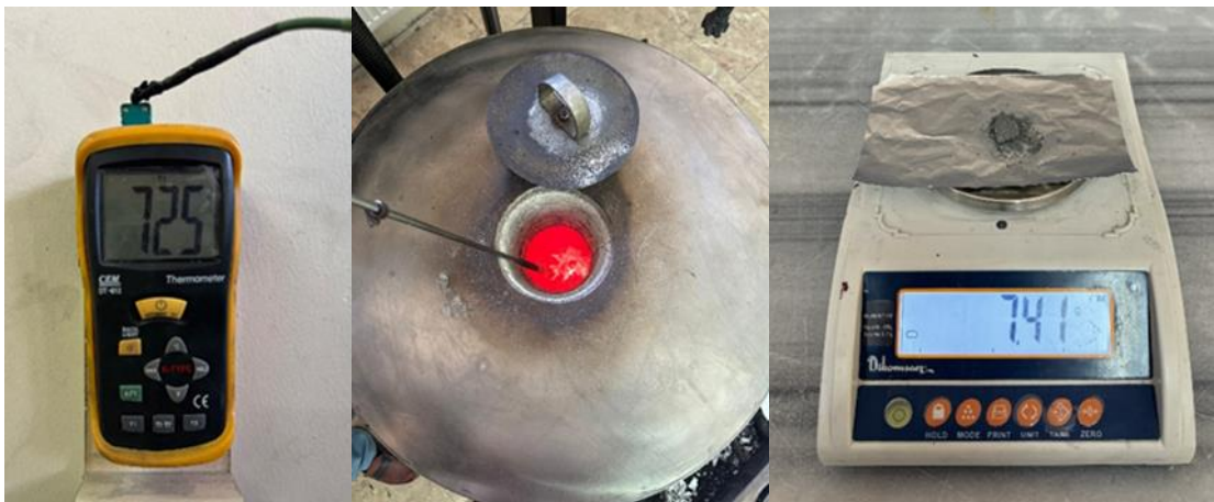
Şekil 11: Mn İlavesi ve Sıcaklık Ölçümü Görselleri
