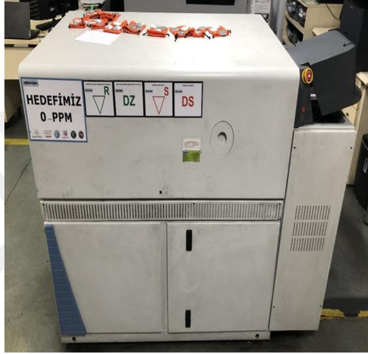
Şekil 14: Numunelerinin Kimyasal Bileşiminin Belirlendiği Spektrometre Cihazı
