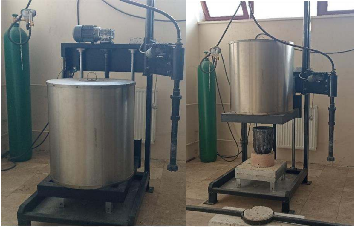
Şekil 10: Elektrik Direnç Ocağı ve SiC Pota
