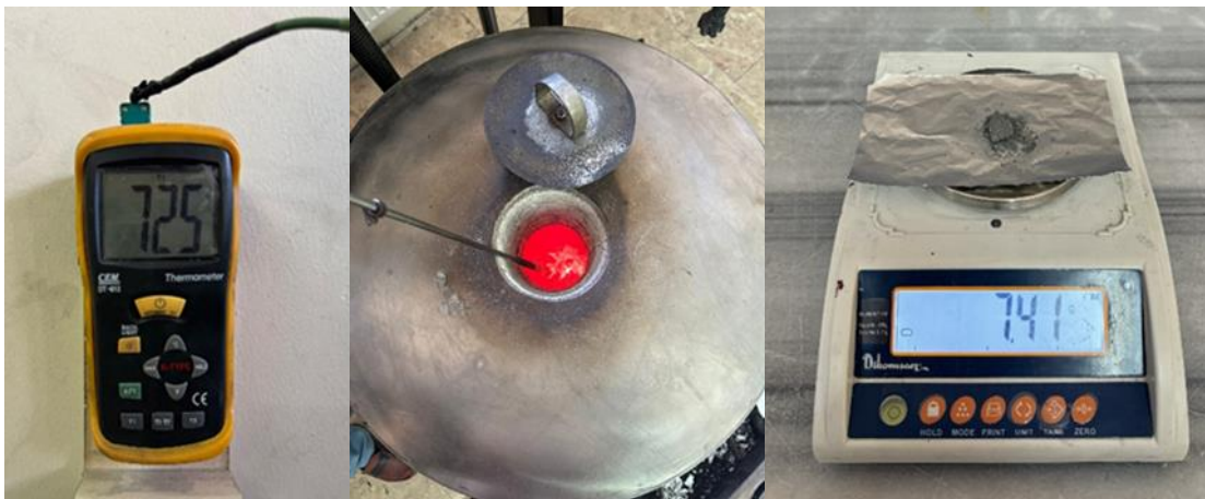
Şekil 11: Mn İlavesi ve Sıcaklık Ölçümü Görselleri
