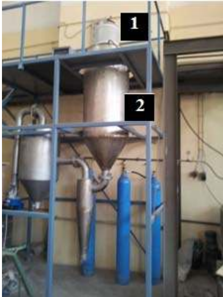
Resim 4.2. Gaz atomizasyonu ünitesi
