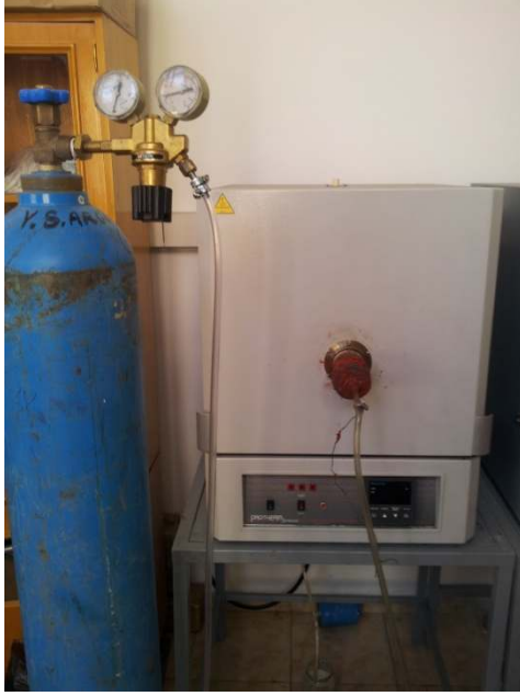
Resim 4.8. Protherm marka sinterleme ısıtım işlem fırını
