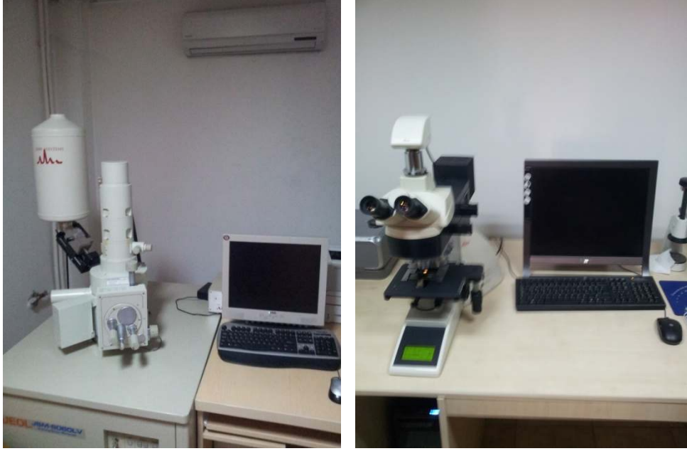
Resim 4.10. a) JEOL JSM-6060 marka taramalı elektron mikroskobu (SEM)
