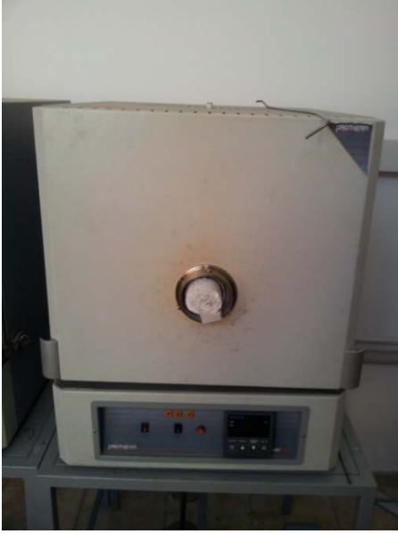
Resim 4.9. Protherm marka çözündürme ve yaşlandırma ısıtma işlemi için açık atmosferli fırın
