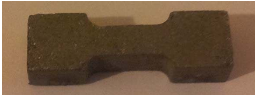
Resim 4.12. Mekanik test numunesi
