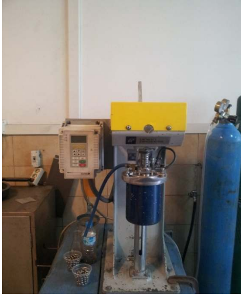
Resim 4.5. Union process marka mekanik alaşımlama cihazı
