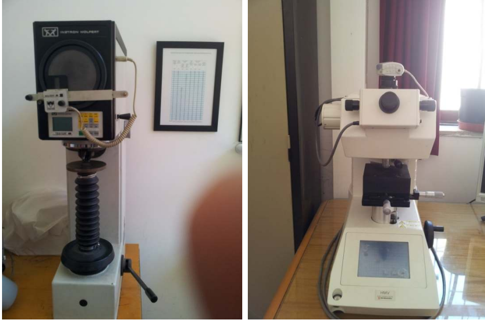
Resim 4.11. a) Instron Wolpert marka makro sertlik test cihazı
