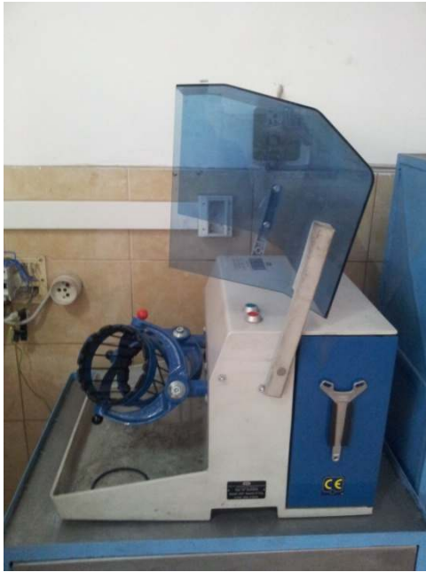
Resim 4.4. Turbula marka 3 boyutlu salınım hareketi yapan karıştırma cihazı
